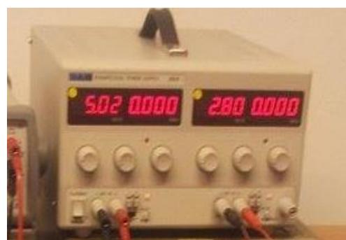
b) Izvor referentnoga napona i mjernoga napona
