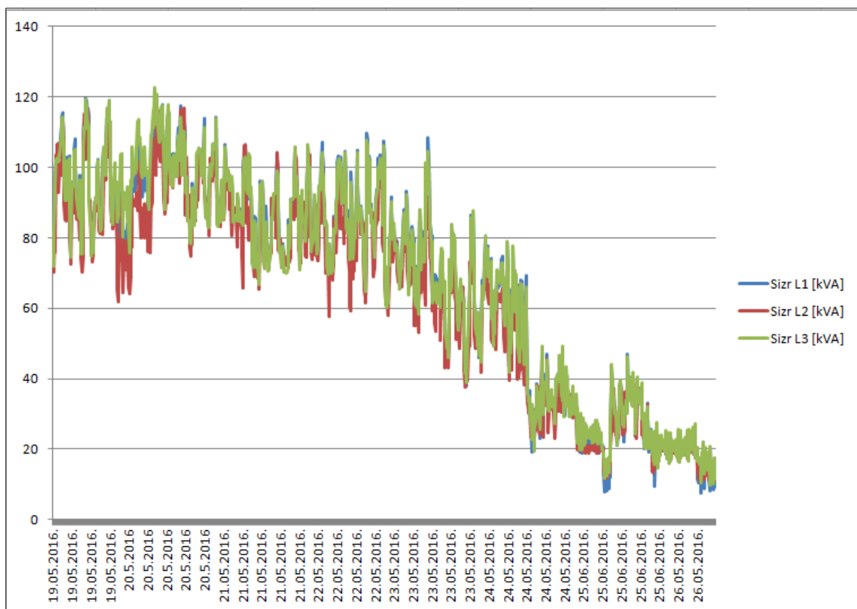
Slika 5.4. Graf mjerene vrijednosti prividne snage na transformatoru
