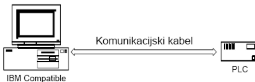
Slika 2.2. Komunikacija računala s PLC-om [4]
