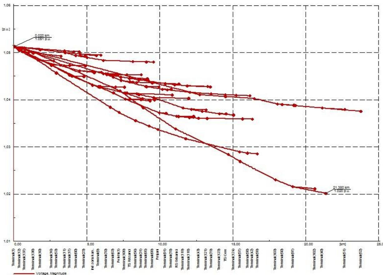
Slika 5.12. Naponski profil izvoda TS Vinčent uz maksimalno opterećenje
