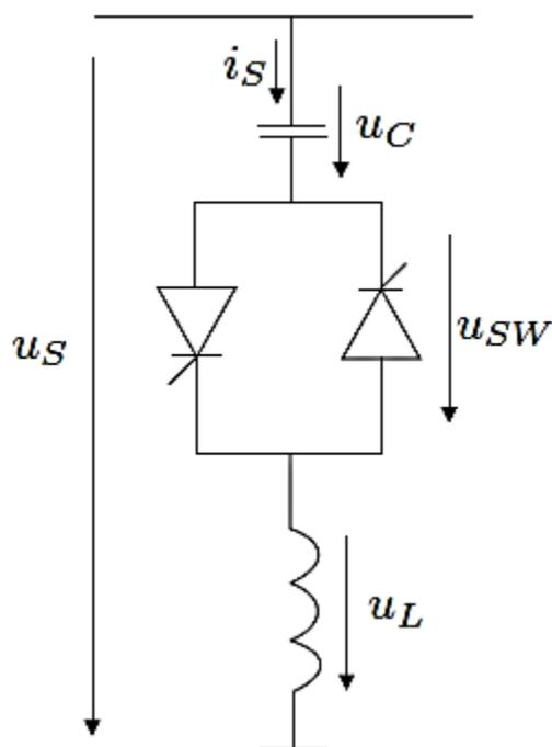
Slika 4.3. Shema distribucijskog statičkog Var kompenzatora [2]
