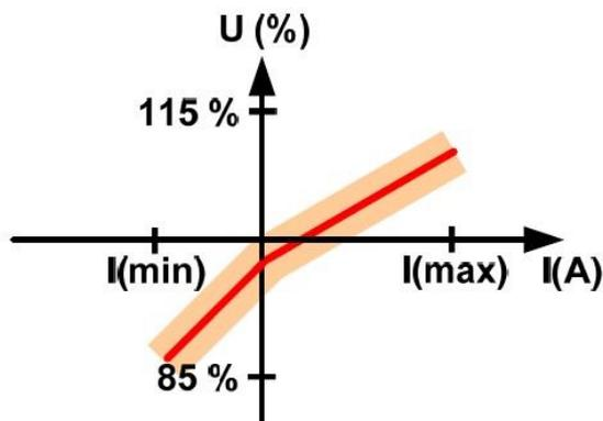
Slika 4.11. Usmjerenom strujno zavisna karakteristika automatske regulacije napona [30]
