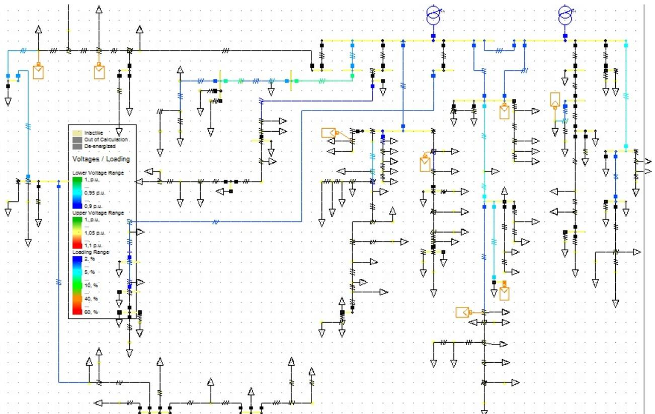
Slika 5.17. Opterećenje dalekovoda i kablova pri minimalnom opterećenju
