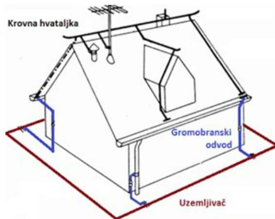
Slika 2.2. Izvedba gromobranskog uzemljenja na primjeru kuće
