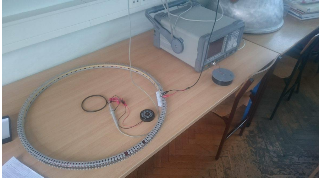
Slika 4.1.4 Položaj prijemnika u odnosu na predajnik (središte)
