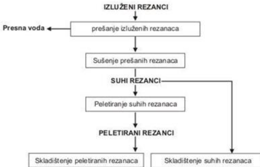
Slika 3.5. Dijagram procesa obrade rezanaca (preuzeto iz [2])
