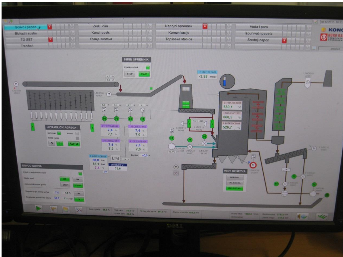
Slika 3.17. Shema procesa goriva i pepela
