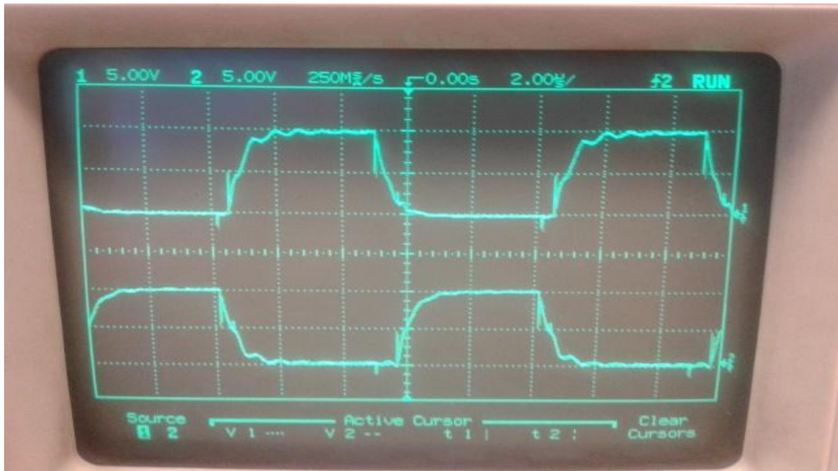
Slika 6.9 Valni oblik upravljačkog napona na upravljačkim elektrodama
