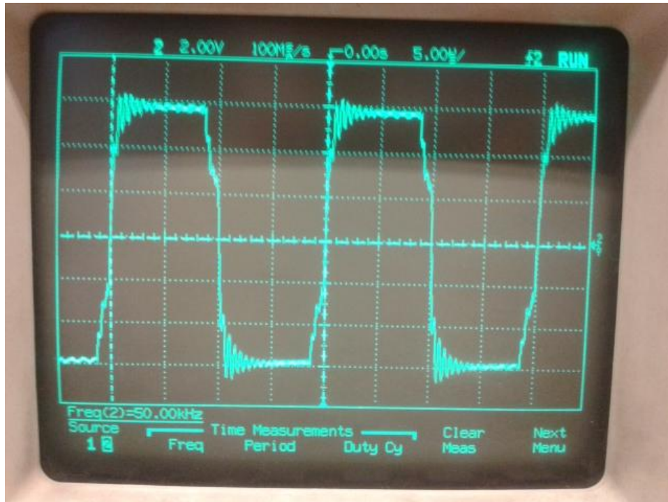
Slika 6.15 Valni oblik na trošilu
