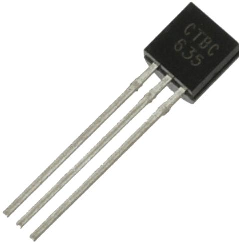
*Slika 4.2 Bipolarni tranzistor*
