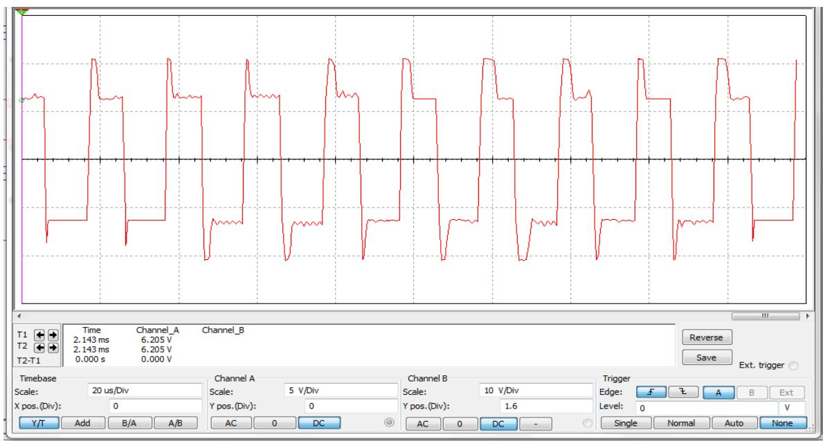
Slika 5.15 Valni oblik napona na trošilu (otpornik R1)
