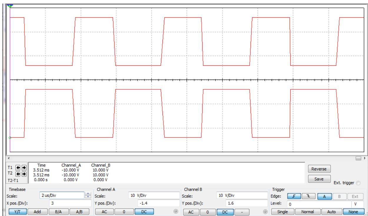
Slika 5.11 Valni oblik upravljačkog napona na upravljačkim elektrodama
