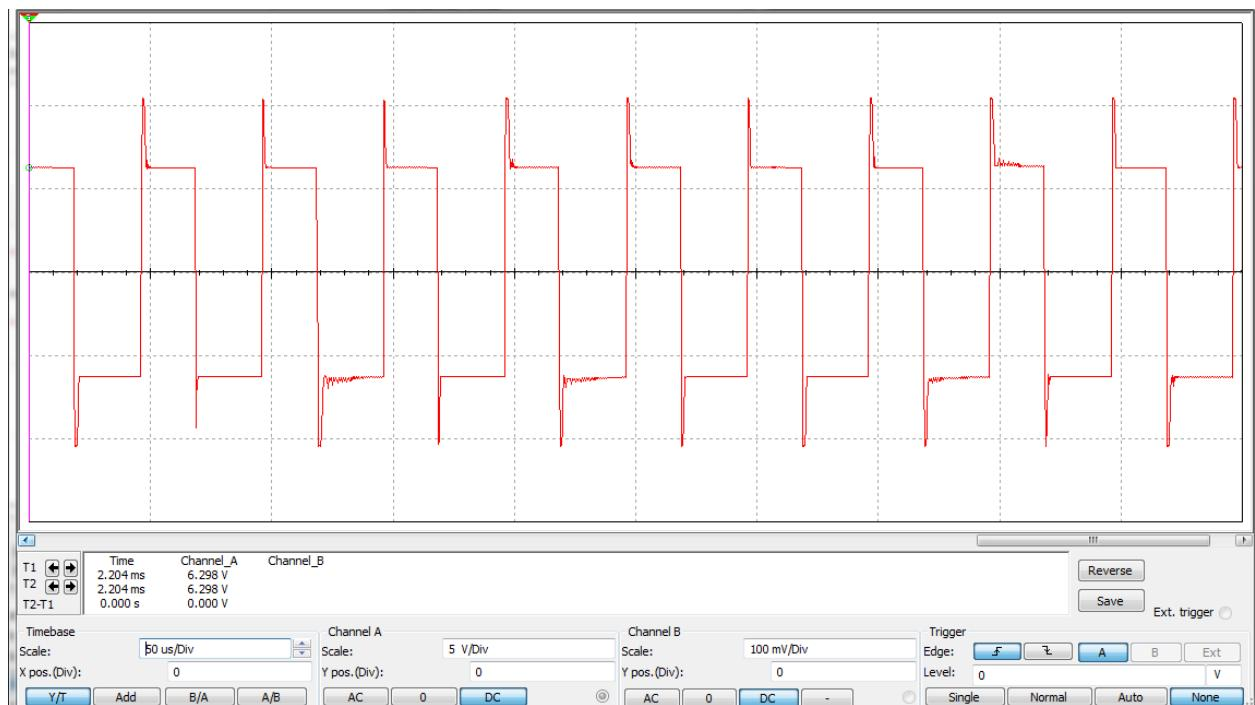
Slika 5.4 Valni oblik napona na trošilu (otpornik R1)
