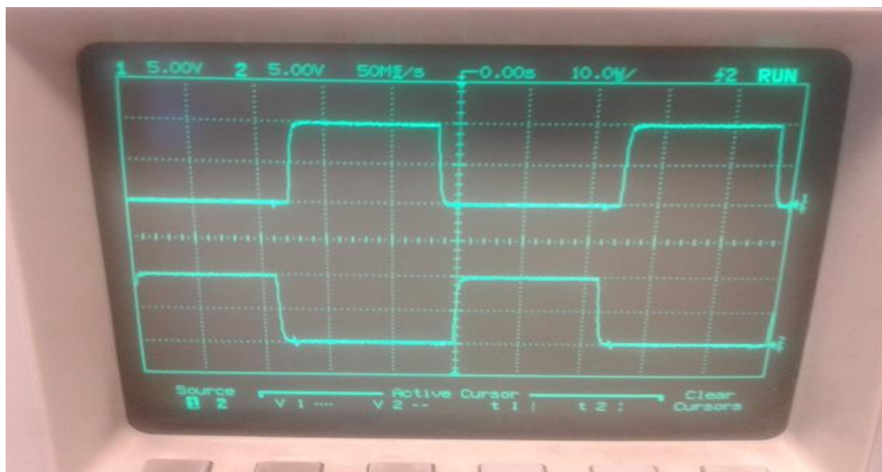
Slika 6.5 Valni oblik upravljačkog napona na upravljačkim elektrodama
