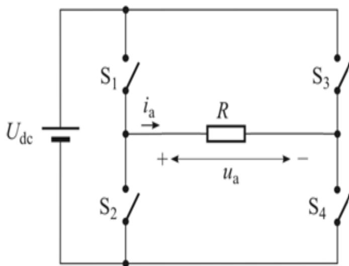
*Slika 3.1 Shematski prikaz izmjenjivača u mosnom spoju*
