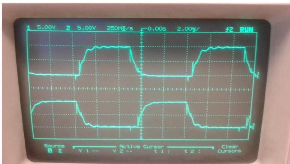
Slika 6.9 Valni oblik upravljačkog napona na upravljačkim elektrodoma
