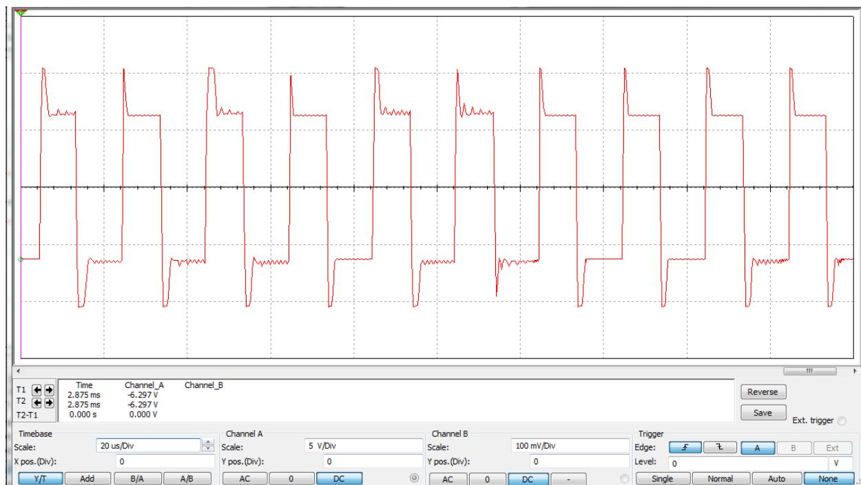
Slika 5.6 Valni oblik napona na trošilu (otpornik R1)
