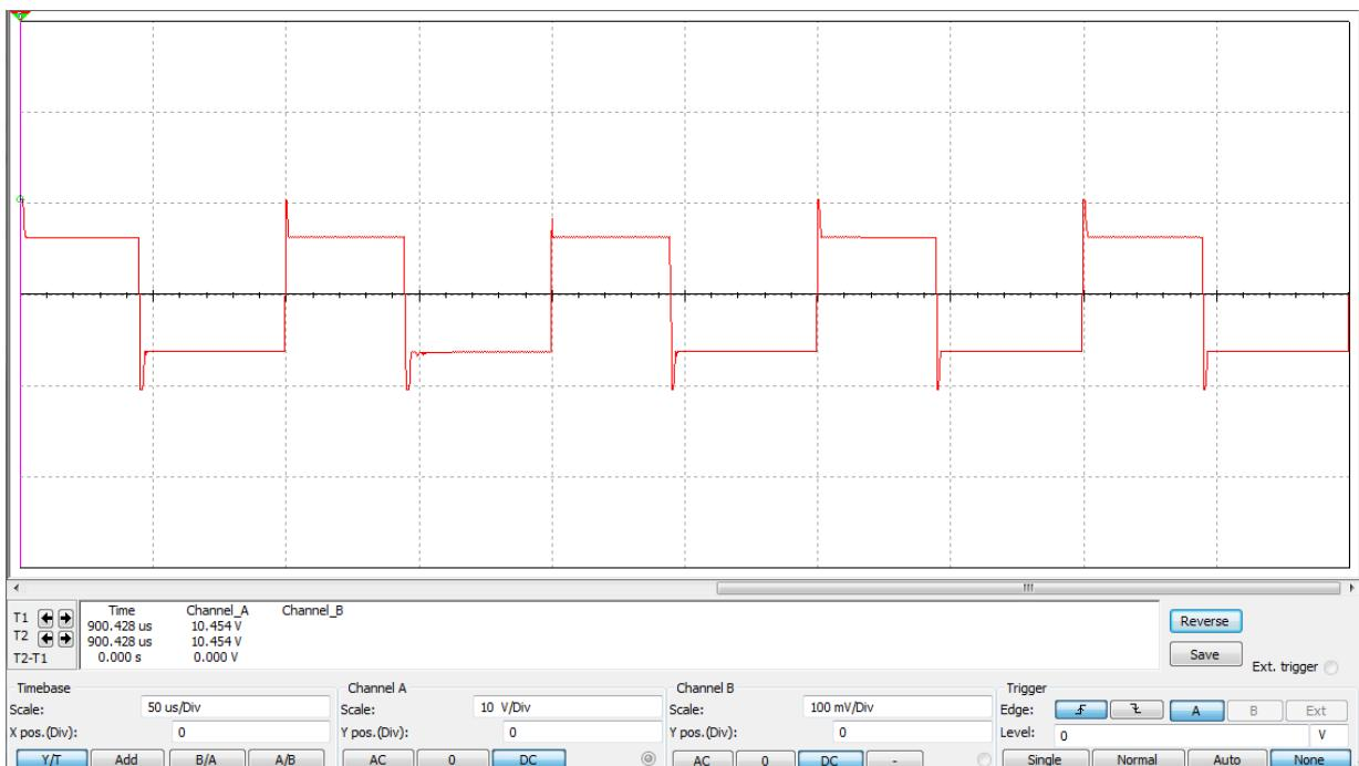
Slika 5.2 Valni oblik napona na trošilu (otpornik R1)
