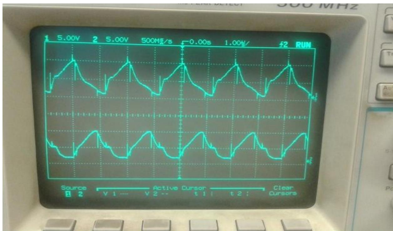
Slika 6.13 Valni oblik upravljačkog napona na upravljačkim elektrodama
