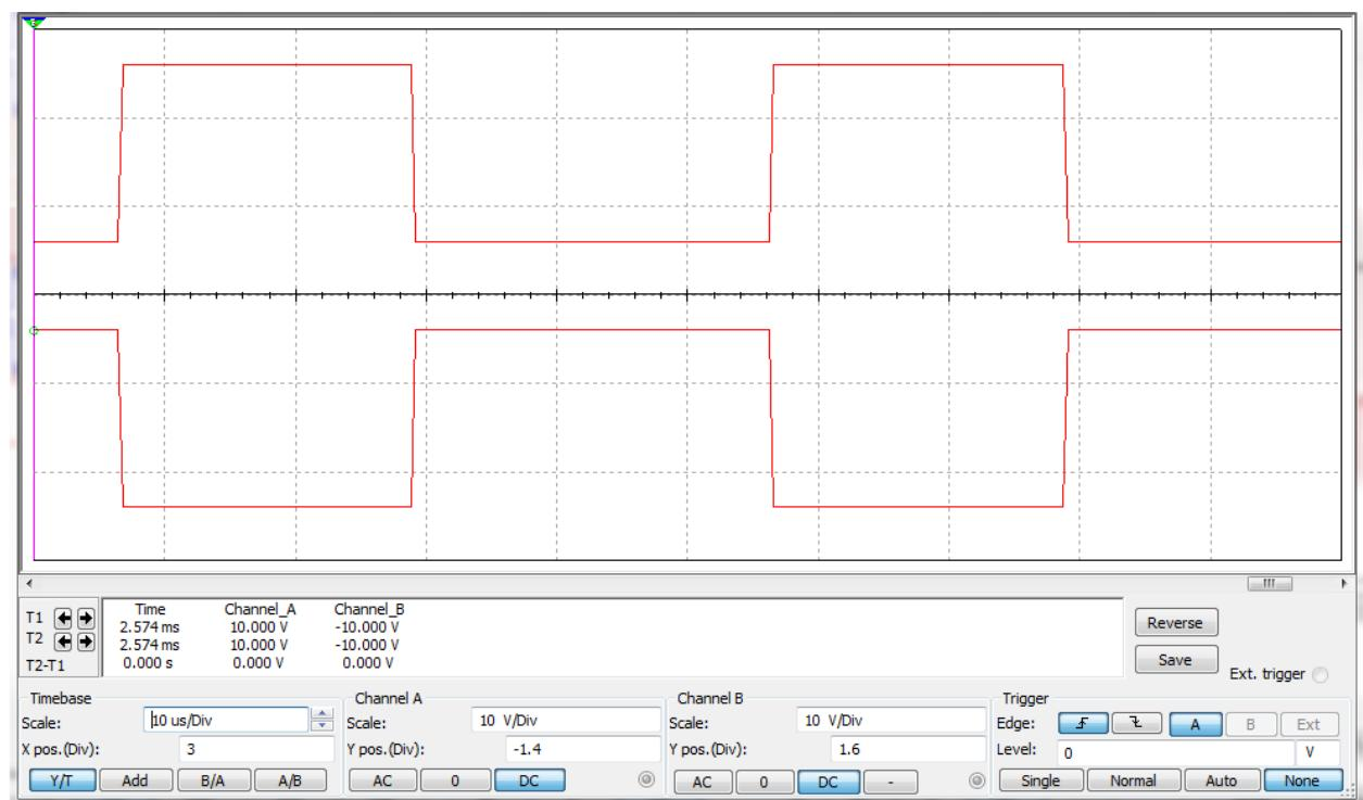
Slika 5.5 Valni oblik upravljačkog napona na upravljačkim elektroda
