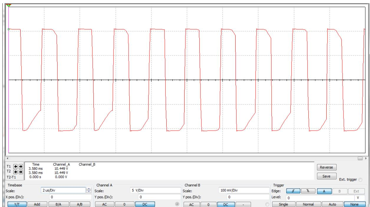
Slika 5.12 Valni oblik napona na trošilu (otpornik R1)
