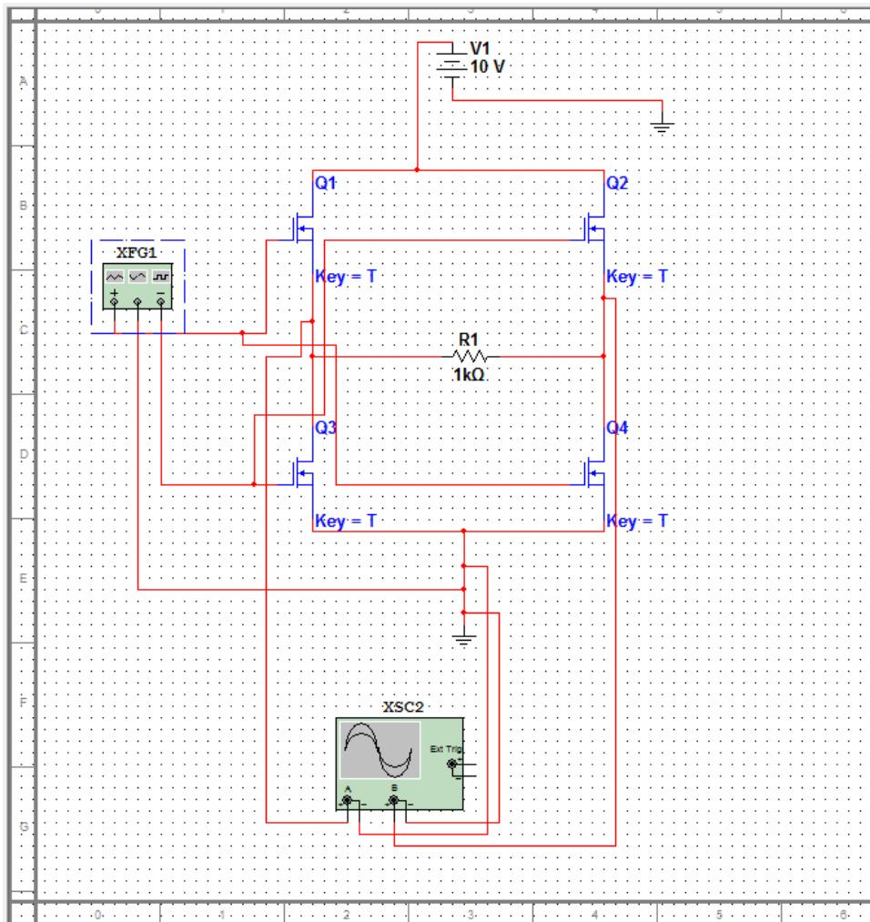
Slika 5.16 Spoj u Multisim-u za mjerjenje valnog oblika između masa i uvoda
