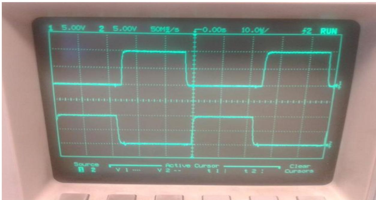
Slika 6.5 Valni oblik upravljačkog napona na upravljačkim elektrodamama
