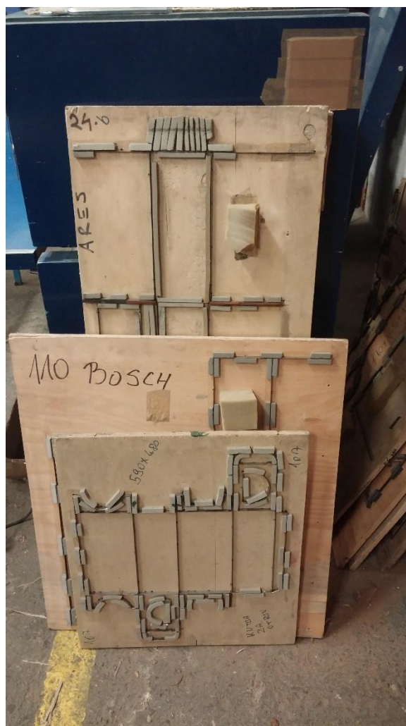
Slika 4.26. Alati za specijalne kutije
