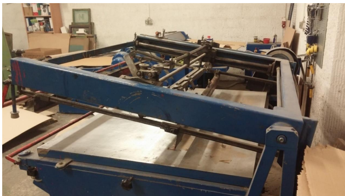
Slika 4.21. Gornji dio stroja za sitotisk, rakel i čistač
