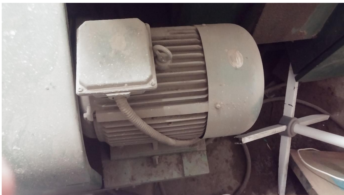
Slika 4.27. Motor zaklopne štanice
