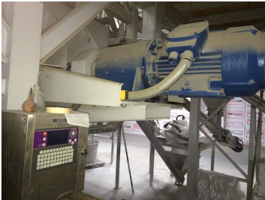
Slika 3.15. Pogonski motor mlina čekićara
