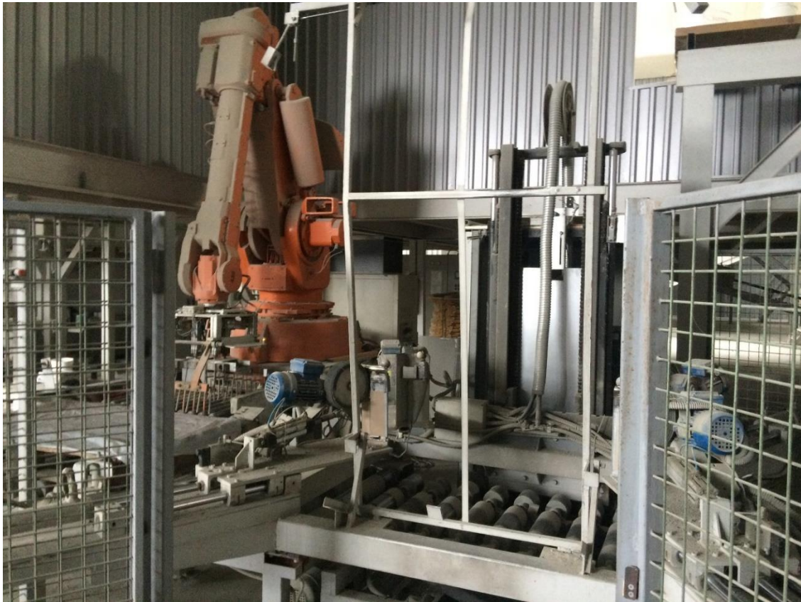
Slika 3.39. Stroj za omotavanje palete folijom
