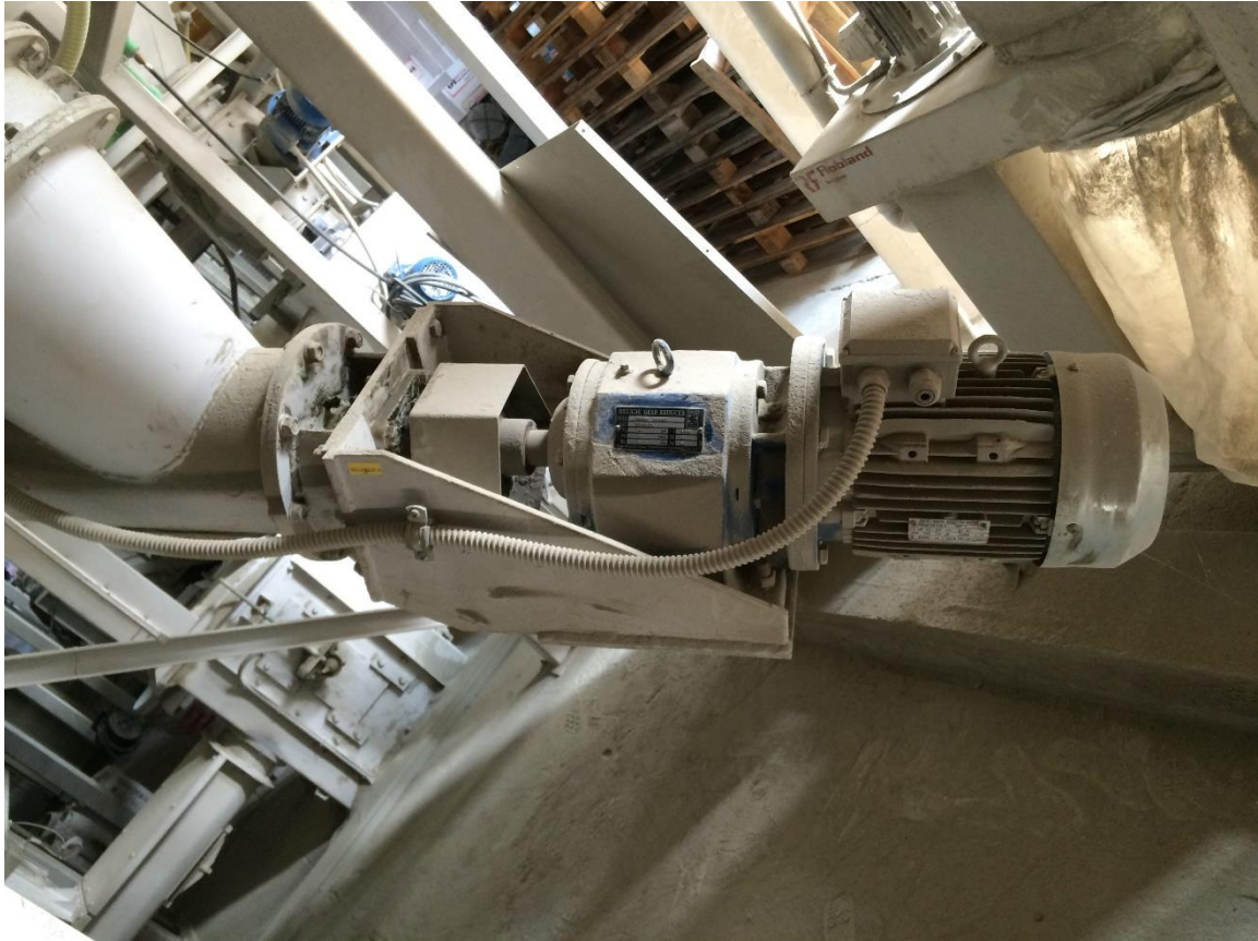
Slika 3.7. Izvedba motora na pužnom transporteru
