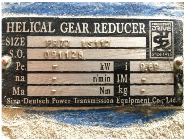
Slika 3.8. Natpisna pločica reduktora
