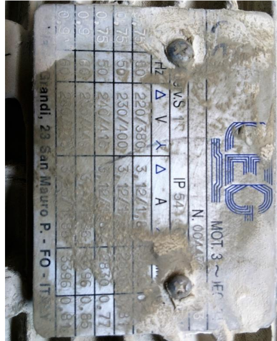
Slika 3.43. Natpisna pločica motora otprašivača
