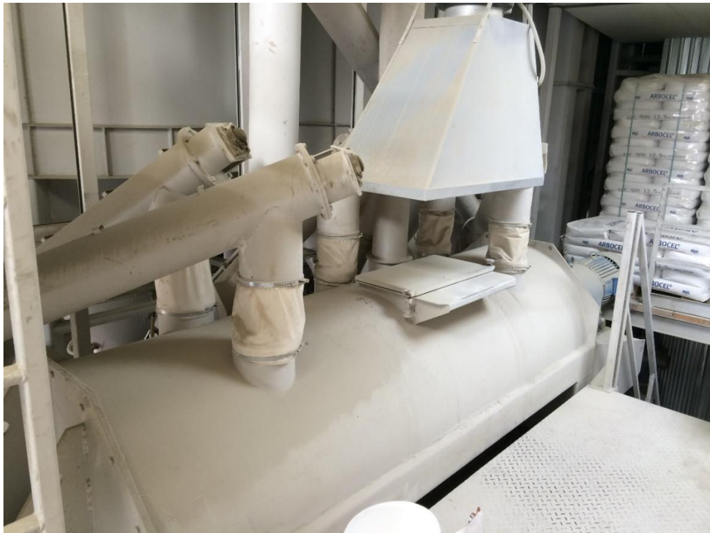
Slika 3.25. Mješalica i usisnik iznad nje
