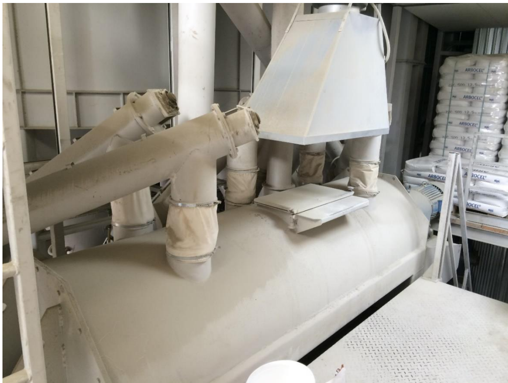
Slika 3.25. Mješalica i usisnik iznad nje
