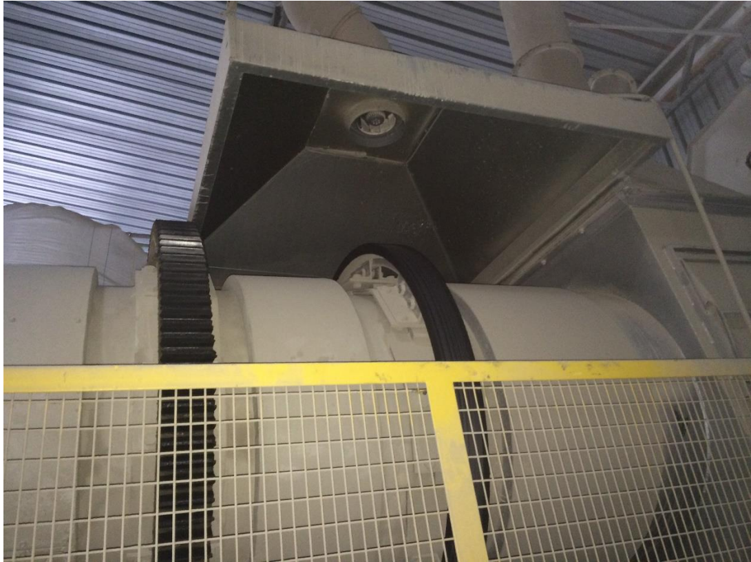
Slika 3.11. Usisnik za usisavanje prašine
