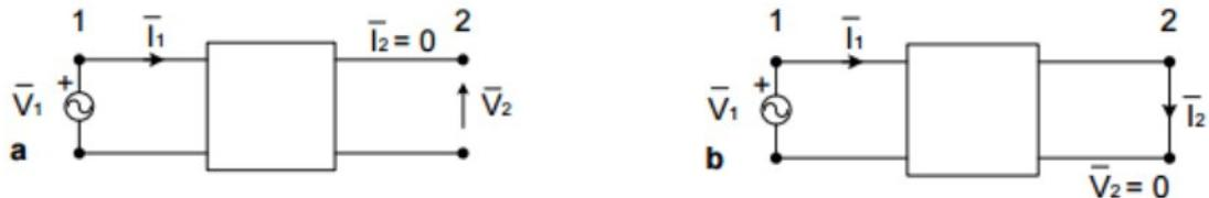
Sl. 2.4. Pokusi za određivanje matrice  $\begin{bmatrix} \bar{L} \end{bmatrix}$  [3]
