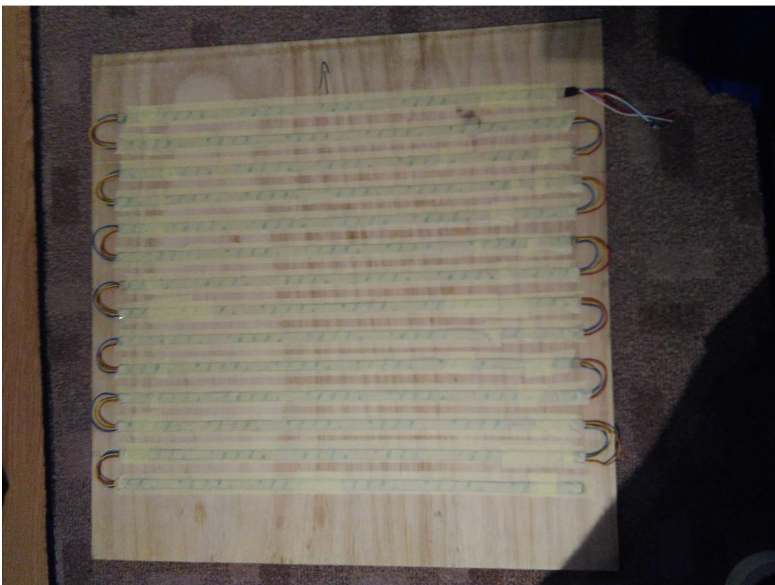
Sl. 3.8 LED-ice pričvršćene ljepljivom trakom
