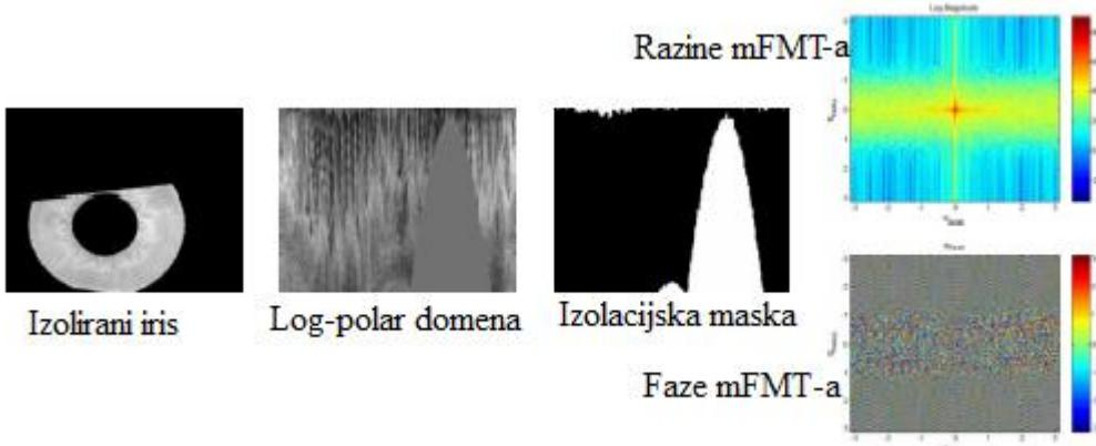
**Slika 4.1** Primjer transofrmacije izolirane maske irisa, u log-polar domenu te u mFMT domenu
