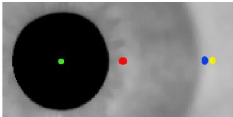
**Slika 3.3** Pronađene točke korištenjem haar wavelet filtra
