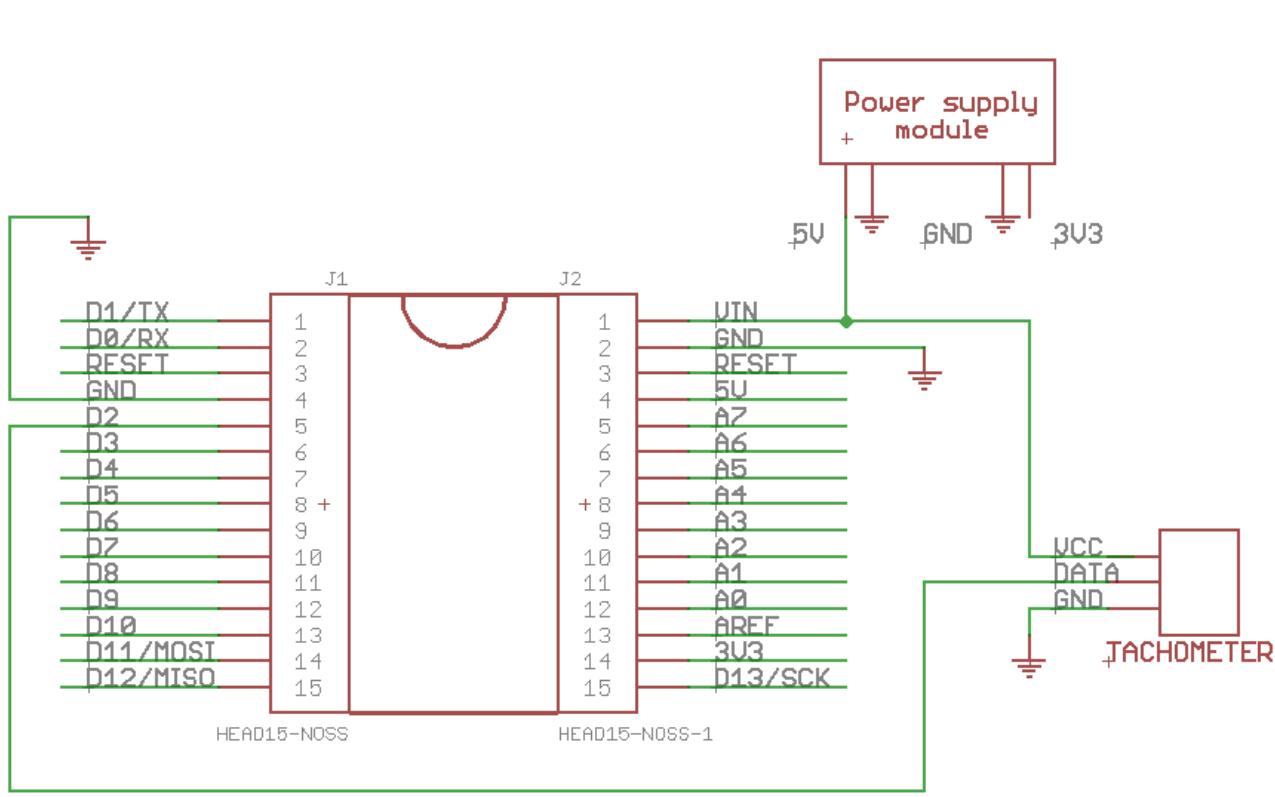
Sl. 3.5. Električna shema spajanja tachometar modula
