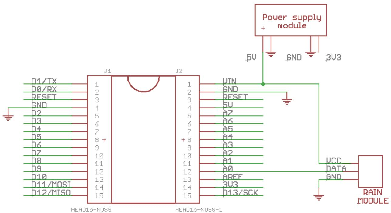
Sl. 3.6. Električna shema spajanja modula za detekciju kiše
