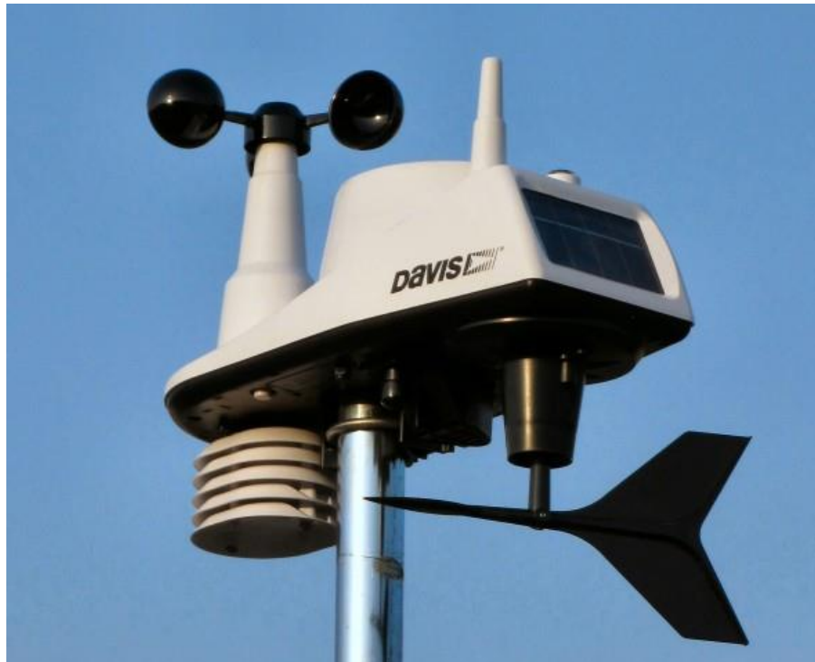
Sl. 1.1 Automatska meteorološka stanica
