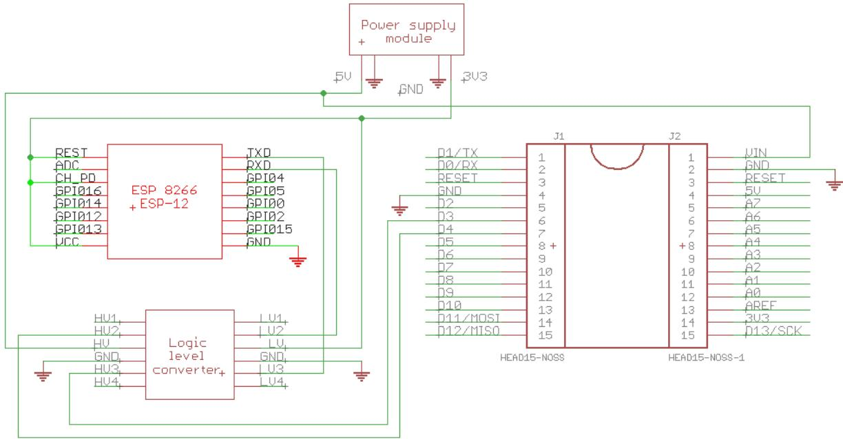
**Sl. 3.7.** Električna shema spajanja WiFi modula i logic level convertera sa Arduinom
