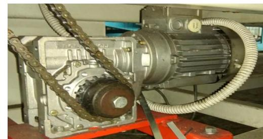
**Slika 3.39.** za pogon prednjih vučnih valjaka stroja VLEKA ŽLEBA 333
