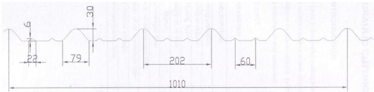
Slika 3.28. Skica (u profilu) crijeva ploče
