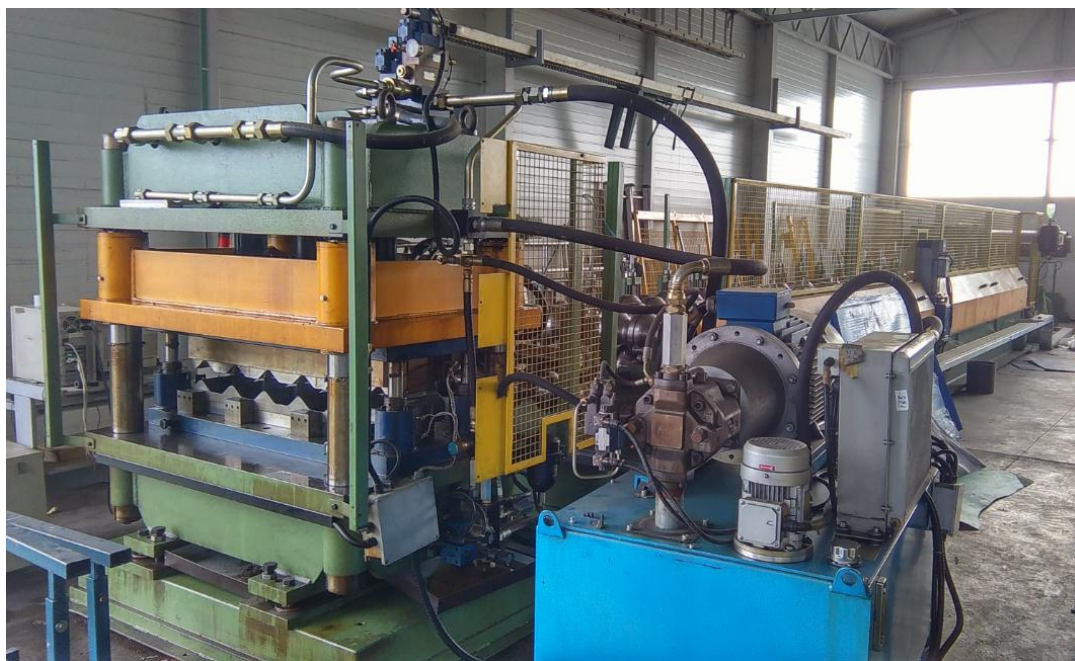
Slika 3.25. Stroj za proizvodnju crijep ploča
