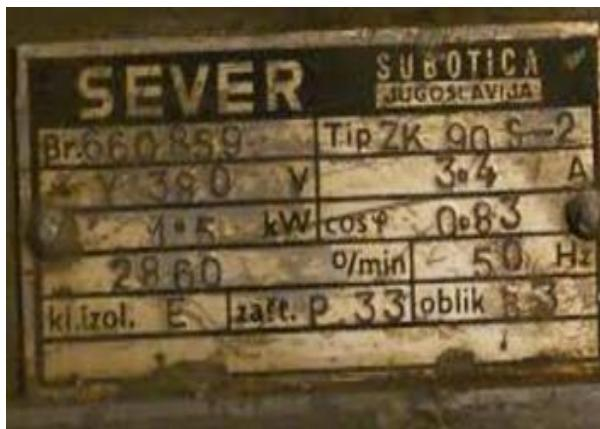
Slika 2.2. Natpisna pločica asinkronog motora
