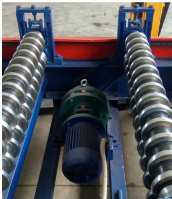
**Slika 3.54.** Pogonski motor s reduktorom – stroj V20/77
