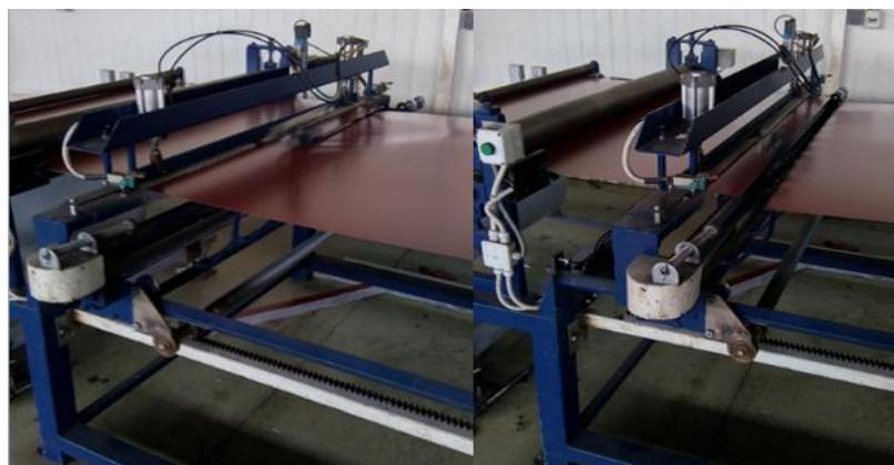
**Slika 3.46.** Škare T-35 stroja u procesu rezanja lima
