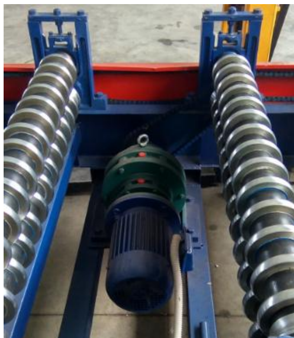
Slika 3.54. Pogonski motor s reduktorom – stroj V20/77
