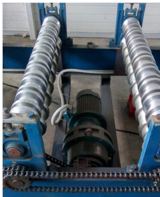
Slika 3.55. Pogonski motor s reduktorom – stroj T-20
