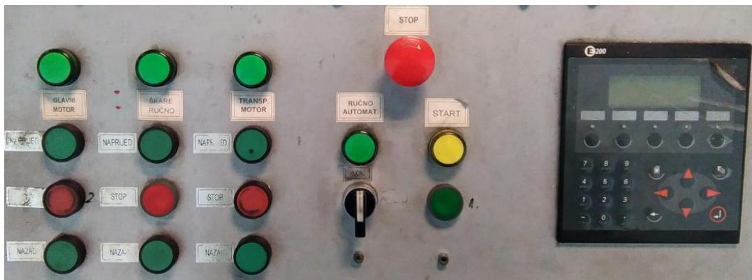
Slika 3.43. Upravljačka ploča T-35 stroja
