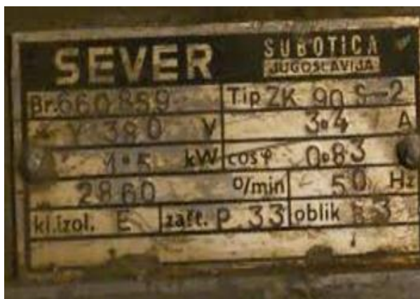
Slika 2.2. Natpisna pločica asinkronog motora
