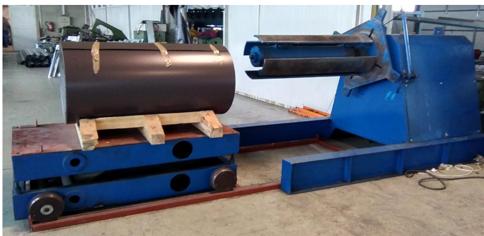
Slika 3.19. Postavljanje role lima na strojna namatalicu
