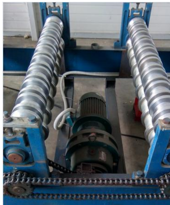
Slika 3.55. Pogonski motor s reduktorom – stroj T-20
