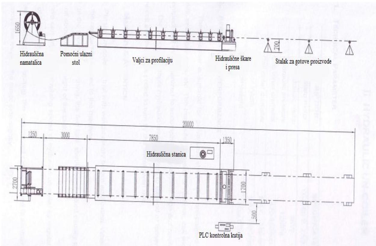
Slika 3.27. Shematski prikaz (tlocrt i bokocrt) stroja za proizvodnju crijeva ploča
