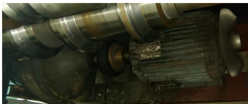
**Slika 3.47.** Pogonski motor T-35 stroja
