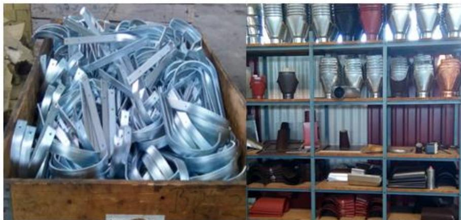
**Slika 3.9.** Kuke (lijevo) i kotlići (desno)
