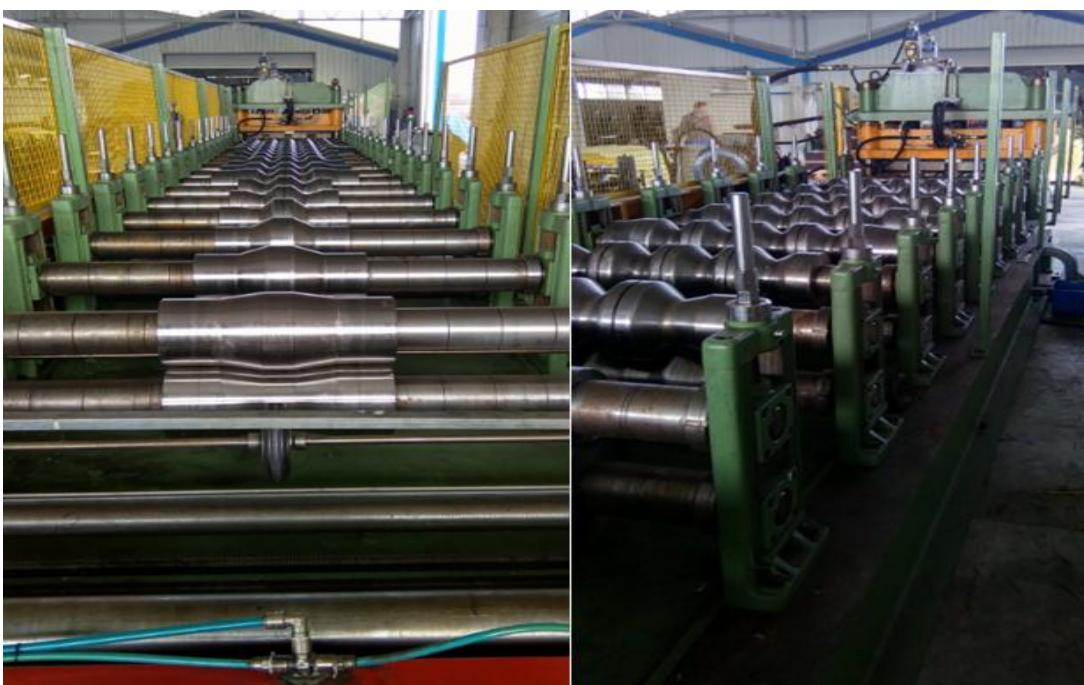
**Slika 3.26.** Stroj za proizvodnju crijepljene ploče – valjci za profilaciju
