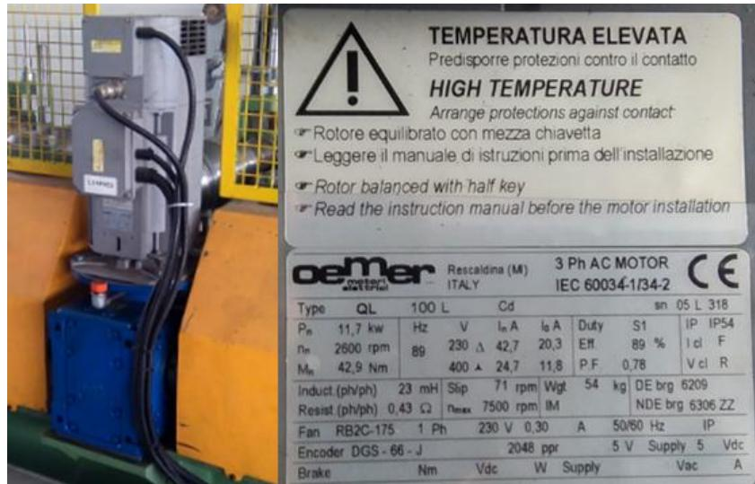
**Slika 3.29.** Motor s reduktorom za pogon valjaka i kada uvećane natpisne pločice motora
