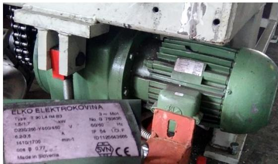
**Slika 3.36.** Pogonski motor stroja VLEKA ŽLEBA 333
