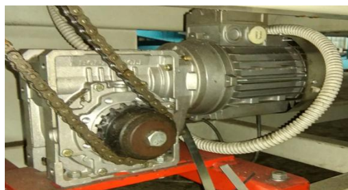
Slika 3.39. Motor za pogon prednjih vučnih valjaka stroja VLEKA ŽLEBA 333
