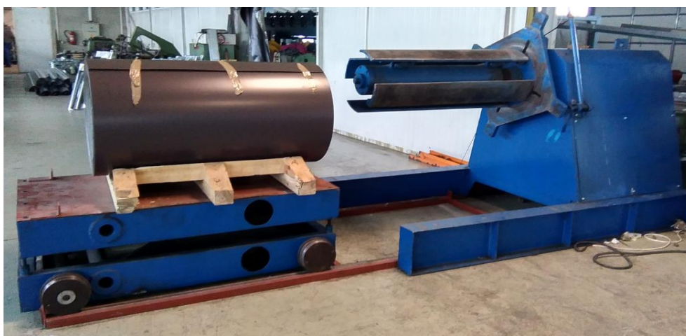
Slika 3.19. Postavljanje role lima na strojna namatalicu
