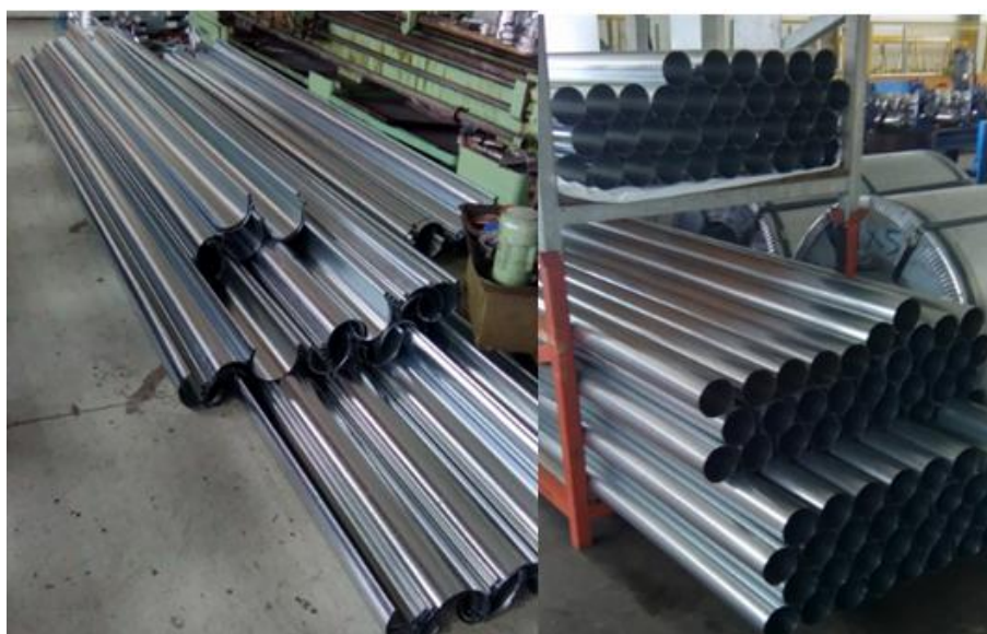
Slika 3.10. Horizontalni (lijevo) i vertikalni (desno) oluci
