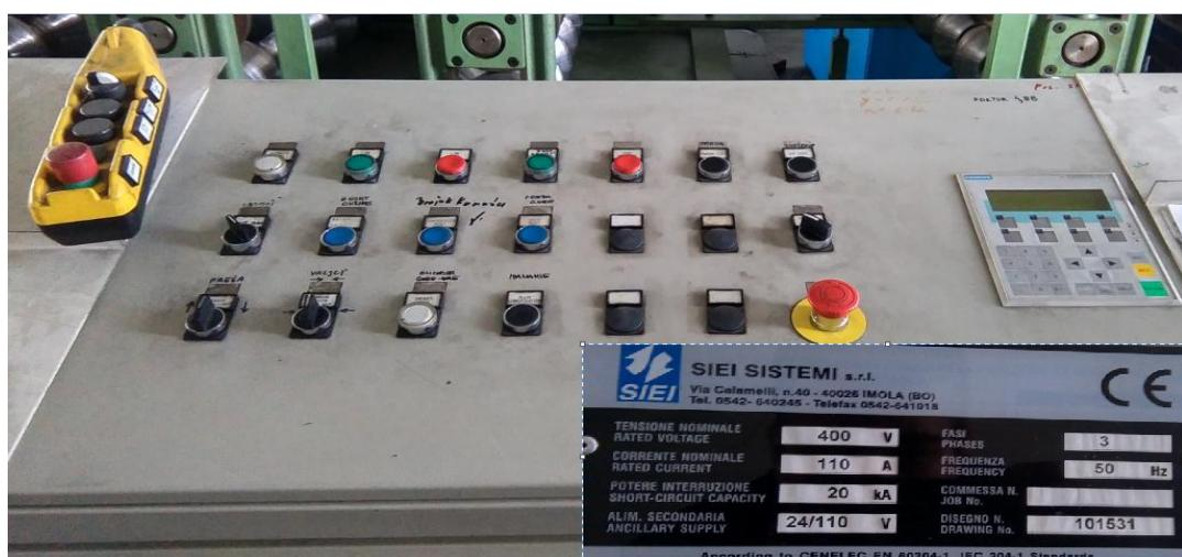
**Slika 3.32.** Upravljačka ploča s uvećanim kadrom natpisne pločice
