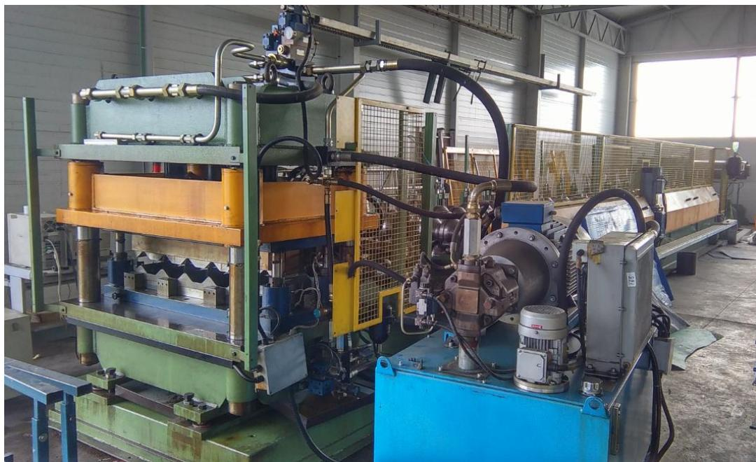
**Slika 3.25.** Stroj za proizvodnju crijepljene ploče
