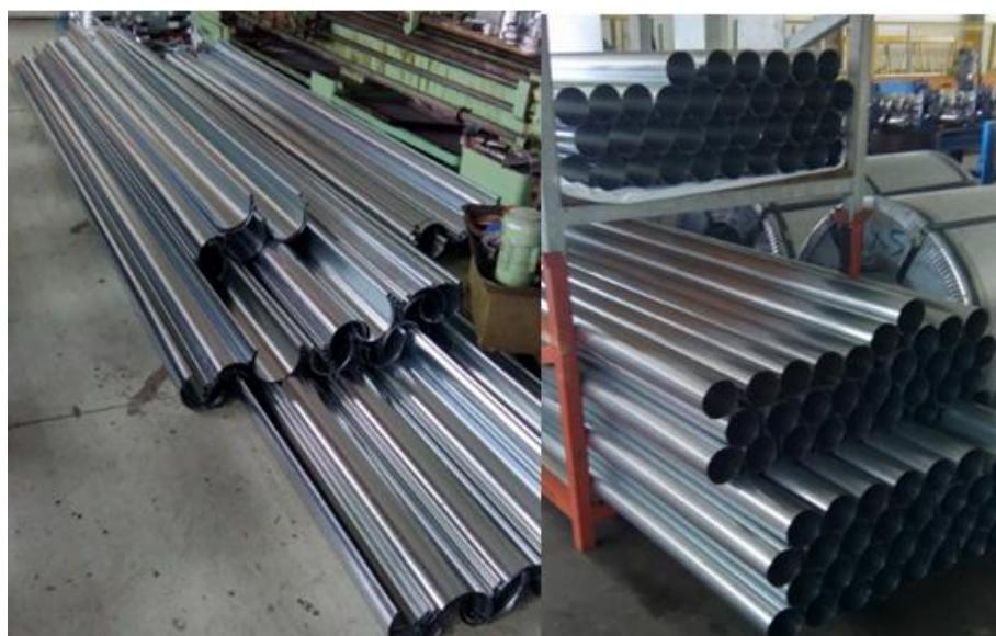
**Slika 3.10.** Horizontalni (lijevo) i vertikalni (desno) oluci
