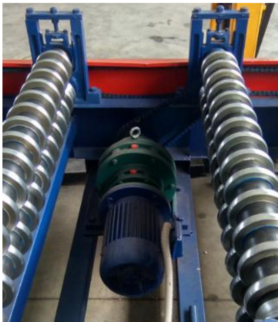
Slika 3.54. Pogonski motor s reduktorom – stroj V20/77
