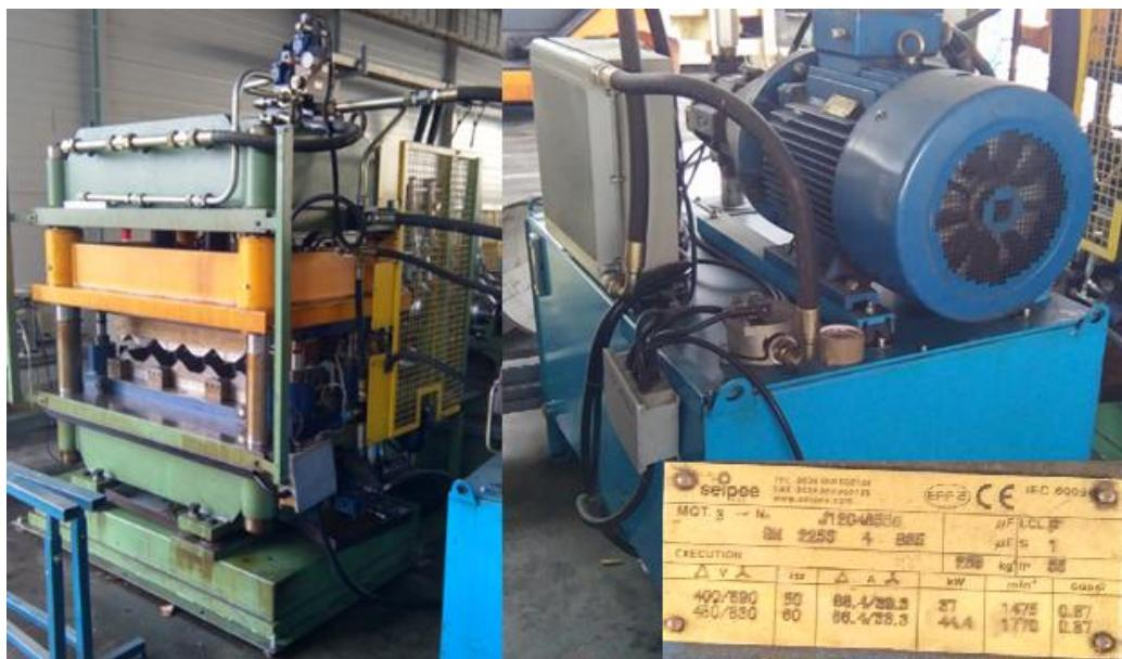
**Slika 3.30.** Hidraulična preša, škare (desno) i stanica s uvećanim kadrom natpisne pločice motora (lijevo)
