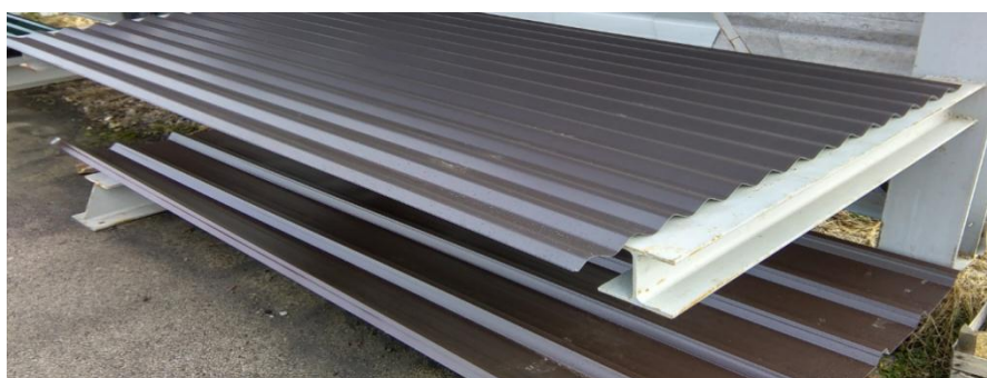
Slika 3.7. Krovni pokrov – ploče u profilu V20/77 (gore) i T-35 (dolje)
