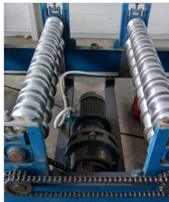
**Slika 3.55.** Pogonski motor s reduktorom – stroj T-20
