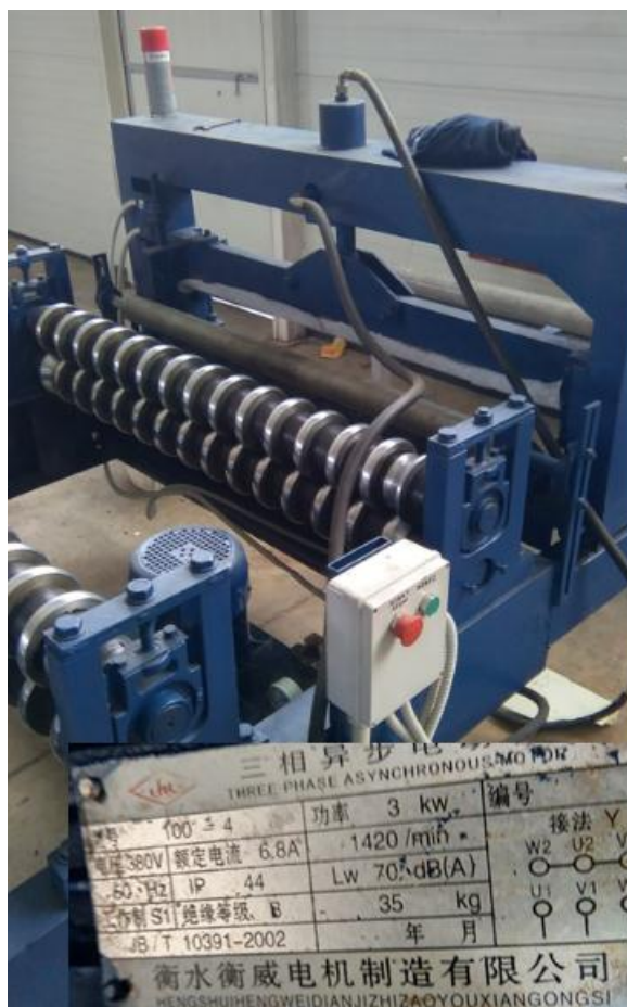
Slika 3.53. Motor za pogon hidrauličnih škara i kadar u kojem je uvećana natpisna pločica motora – stroj V20/77
