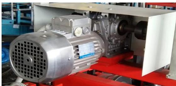
**Slika 3.38.** Motor (s reduktorom) za pogon škara stroja VLEKA ŽLEBA 333
