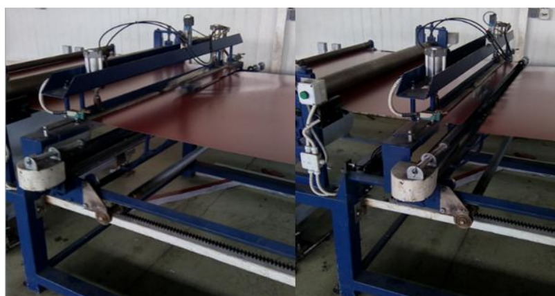
Slika 3.46. Škare T-35 stroja u procesu rezanja lima
