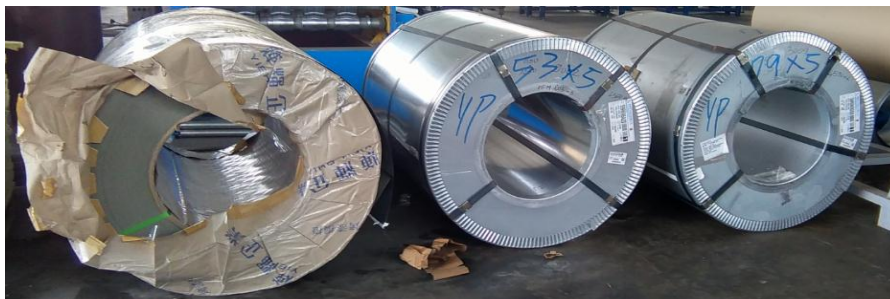
Slika 3.15. Uskladištene, neotpakirane role lima
