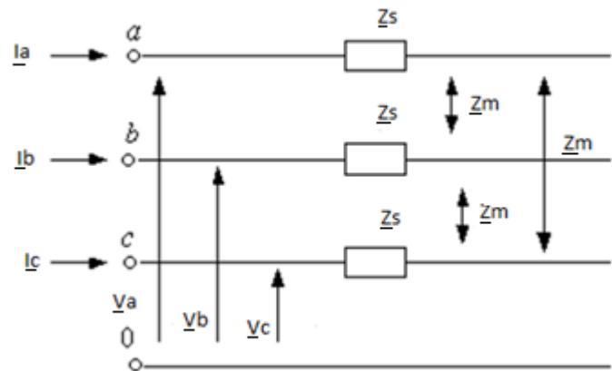
Slika 4.1. Prikaz trofaznog sustava spojenog u zvijezdu
