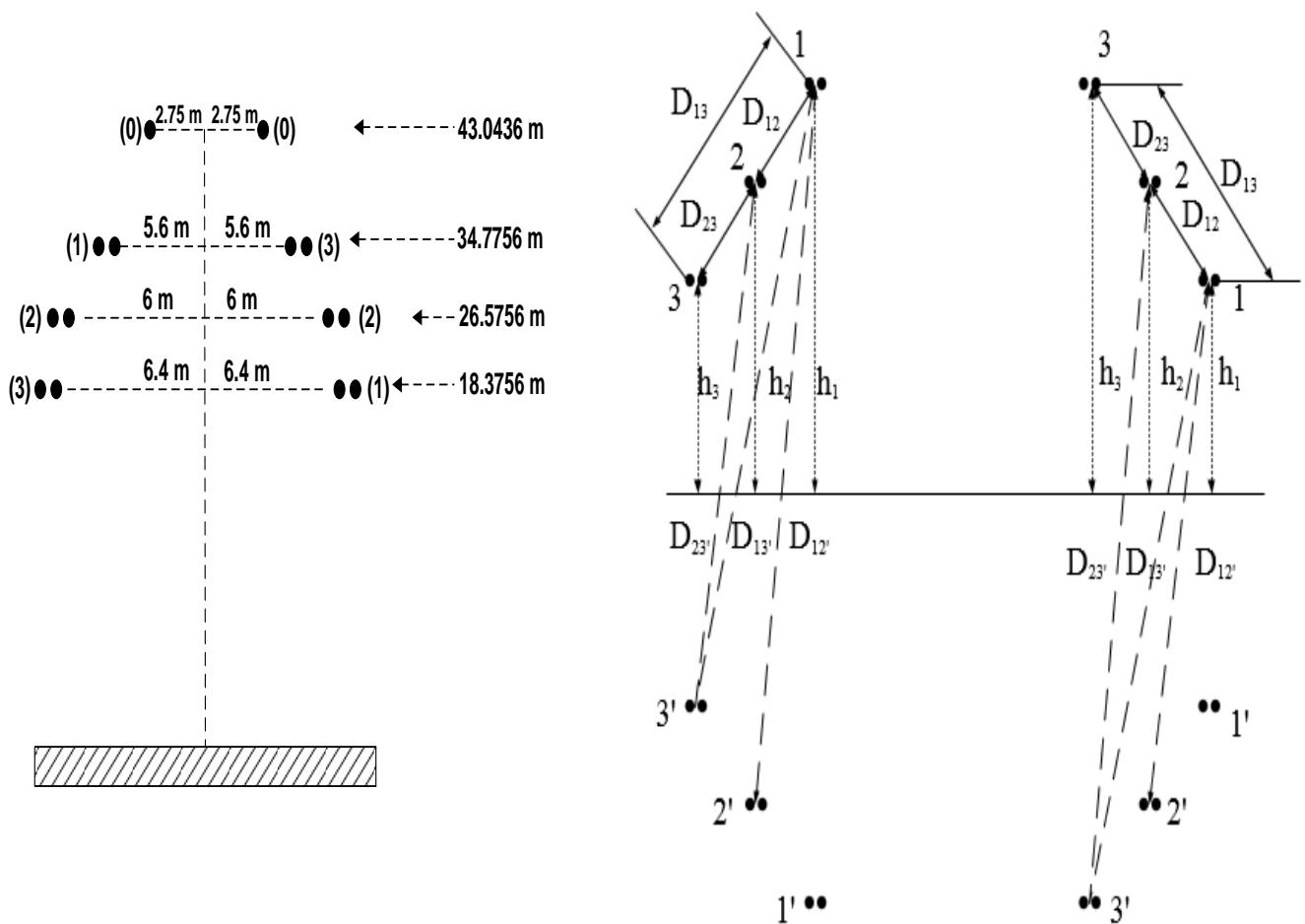
Slika 3.18. Dimenziije nadzemnog voda tipa "trapez"
