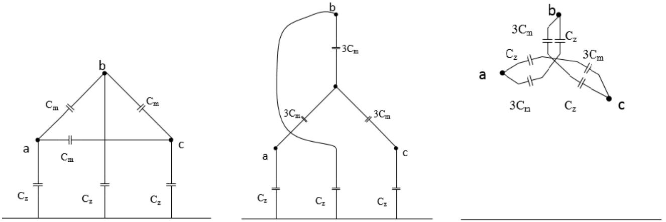
Sl.3.10. Prikaz ovisnosti pogonskog, dozemnog i međusobnog kapaciteta trofaznog simetričnog voda
