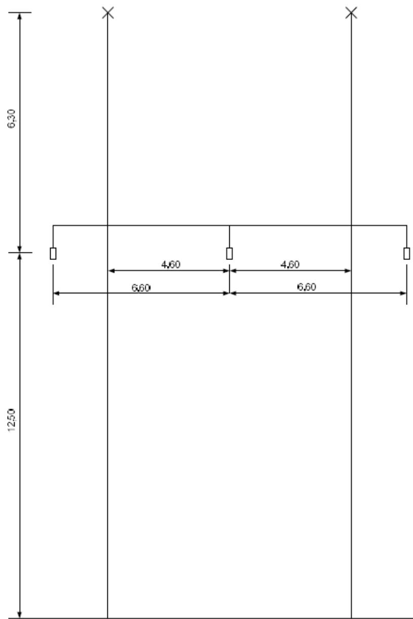
Slika 3.17. Dimenziye nadzemnog voda tipa "portal"
