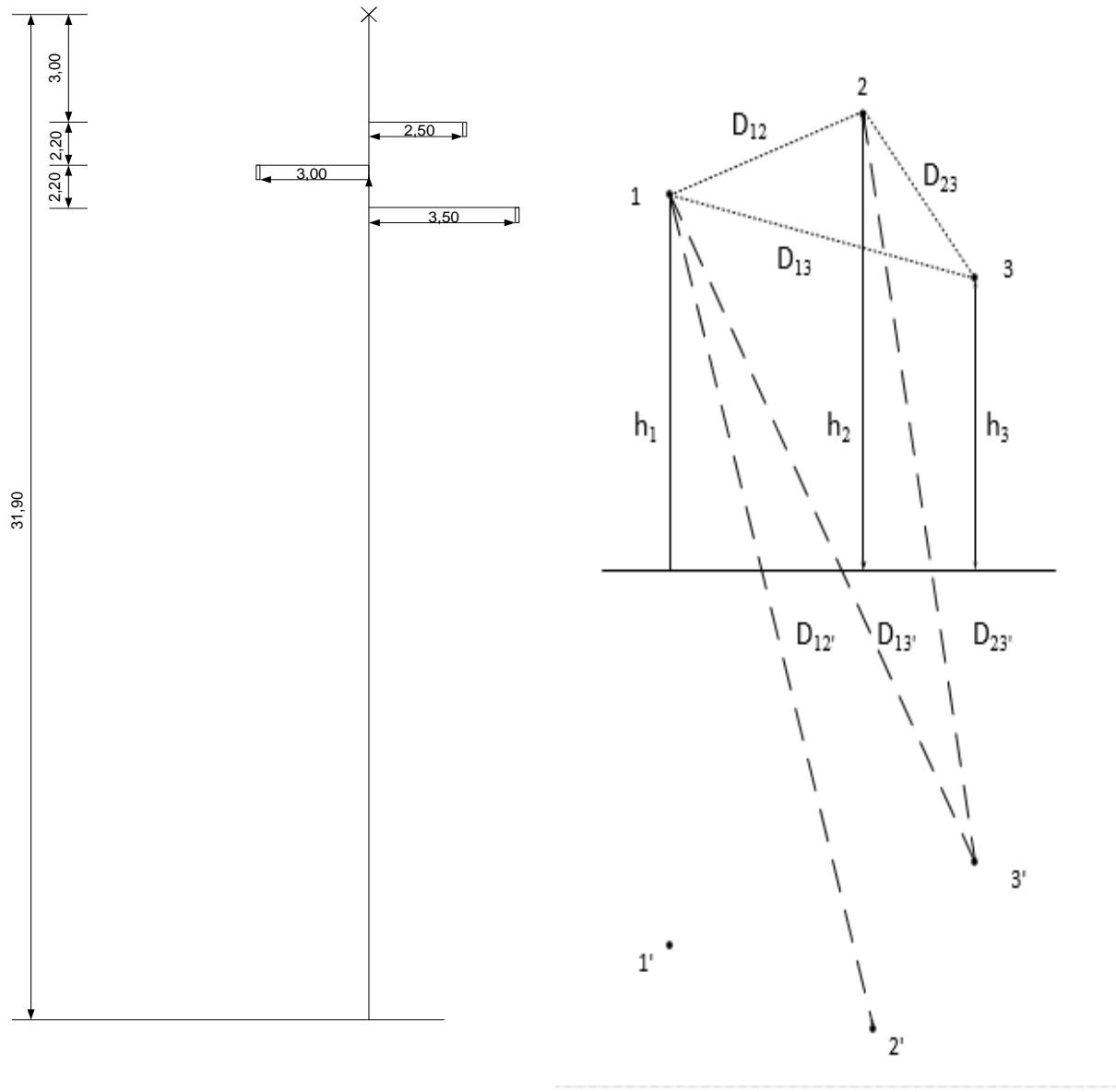
Slika 3.14. Dimenzije nadzemnog voda tipa "jela"
