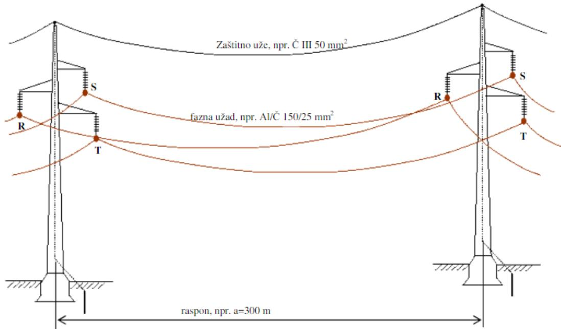
S1.2.1. Dio nadzemnog voda sa osnovnim elementima [3]
