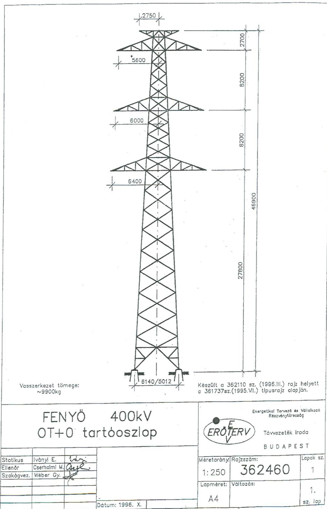
Slika 3.19. Prikaz 400-kV trofaznog dalekovoda tipa "trapez"
