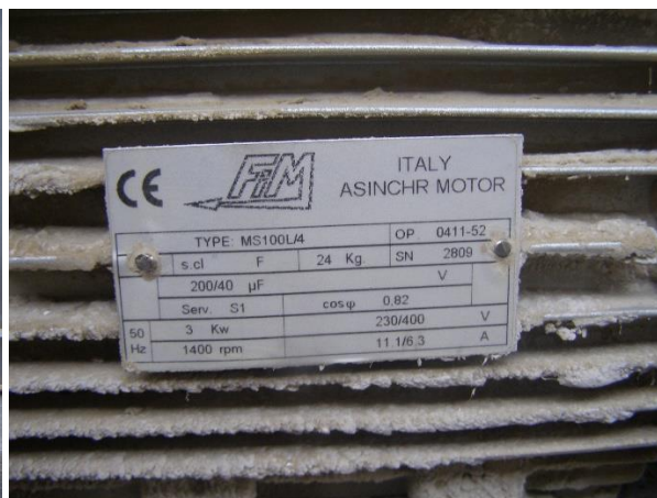
Slika 5.8. Natpisna pločica motora
