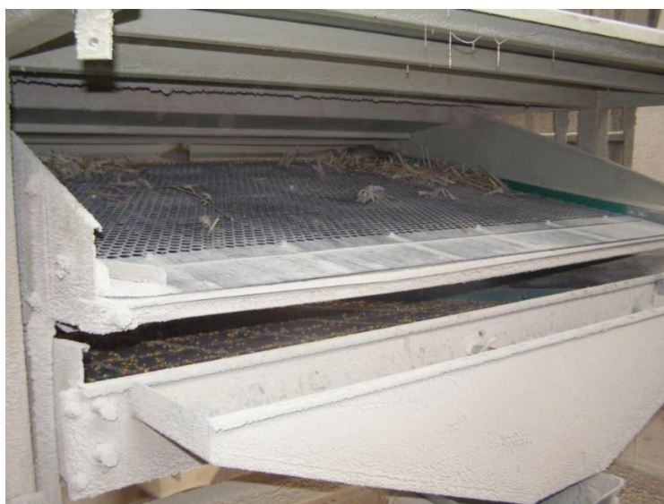
Slika 4.3. Sita prečistača s kanalom za nečistoće
