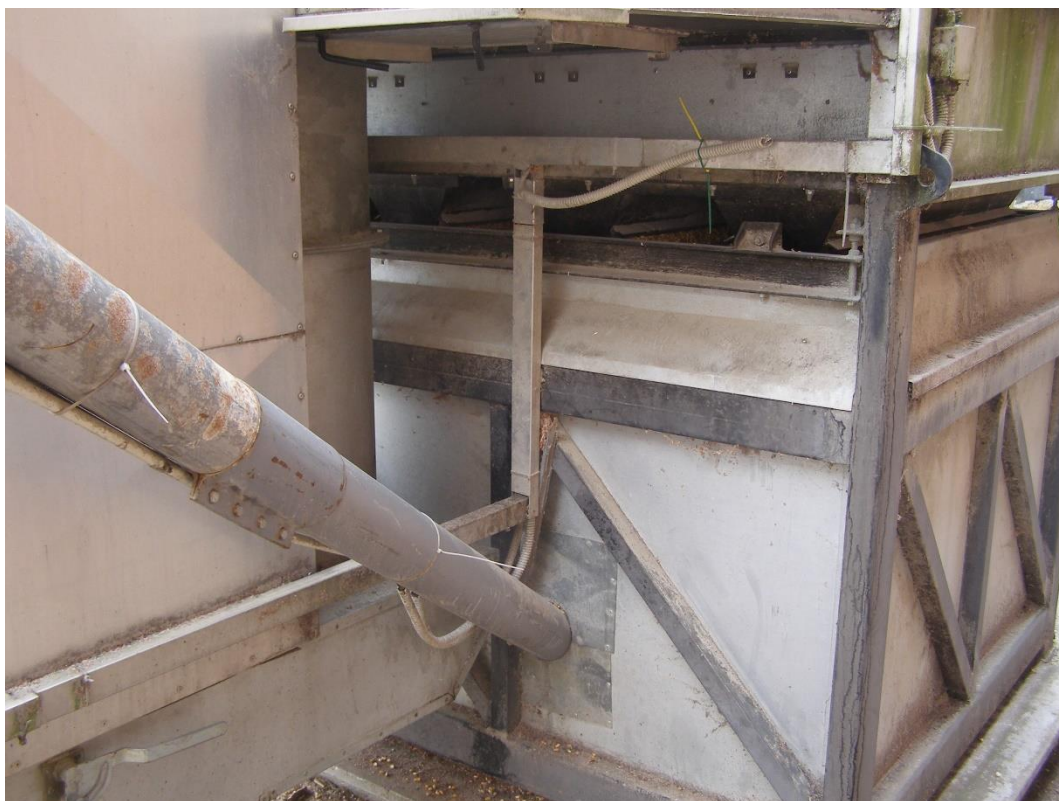
Slika 5.10. Spremnik za zrno ispod izuzimača
