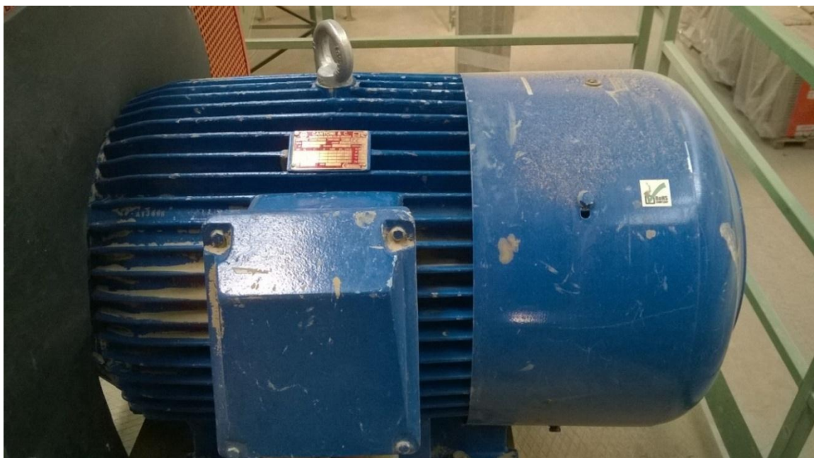
Slika 4.5. Asinkroni motor valjka za grubu preradu
