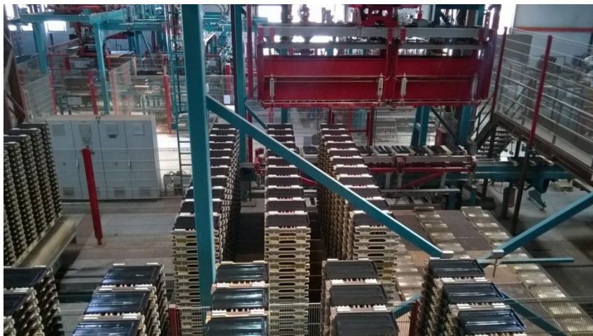
Slika 4.22. Crepovi se pripremaju za pečenje
