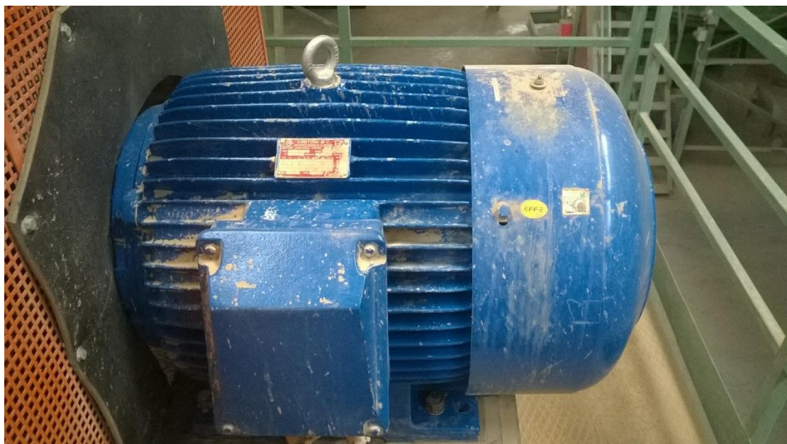
Slika 4.6. Asinkroni motor koji pokreće stroj koji odvaja salitru
