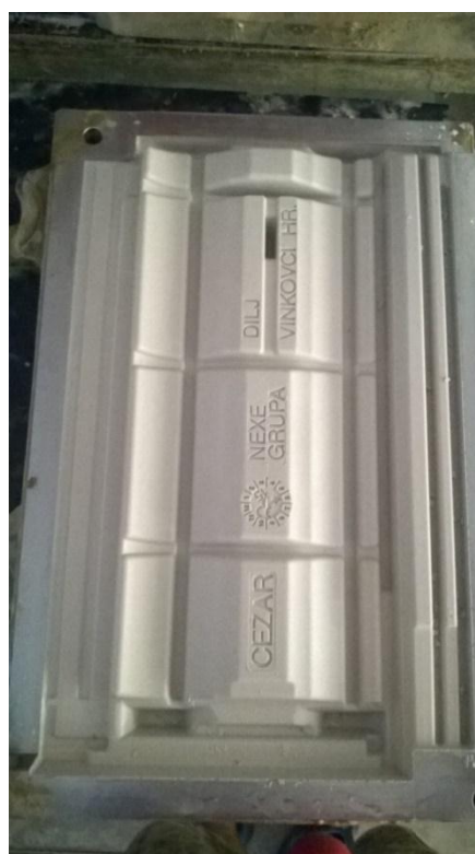
Slika 4.17. Kalup za glinenu plasticu
