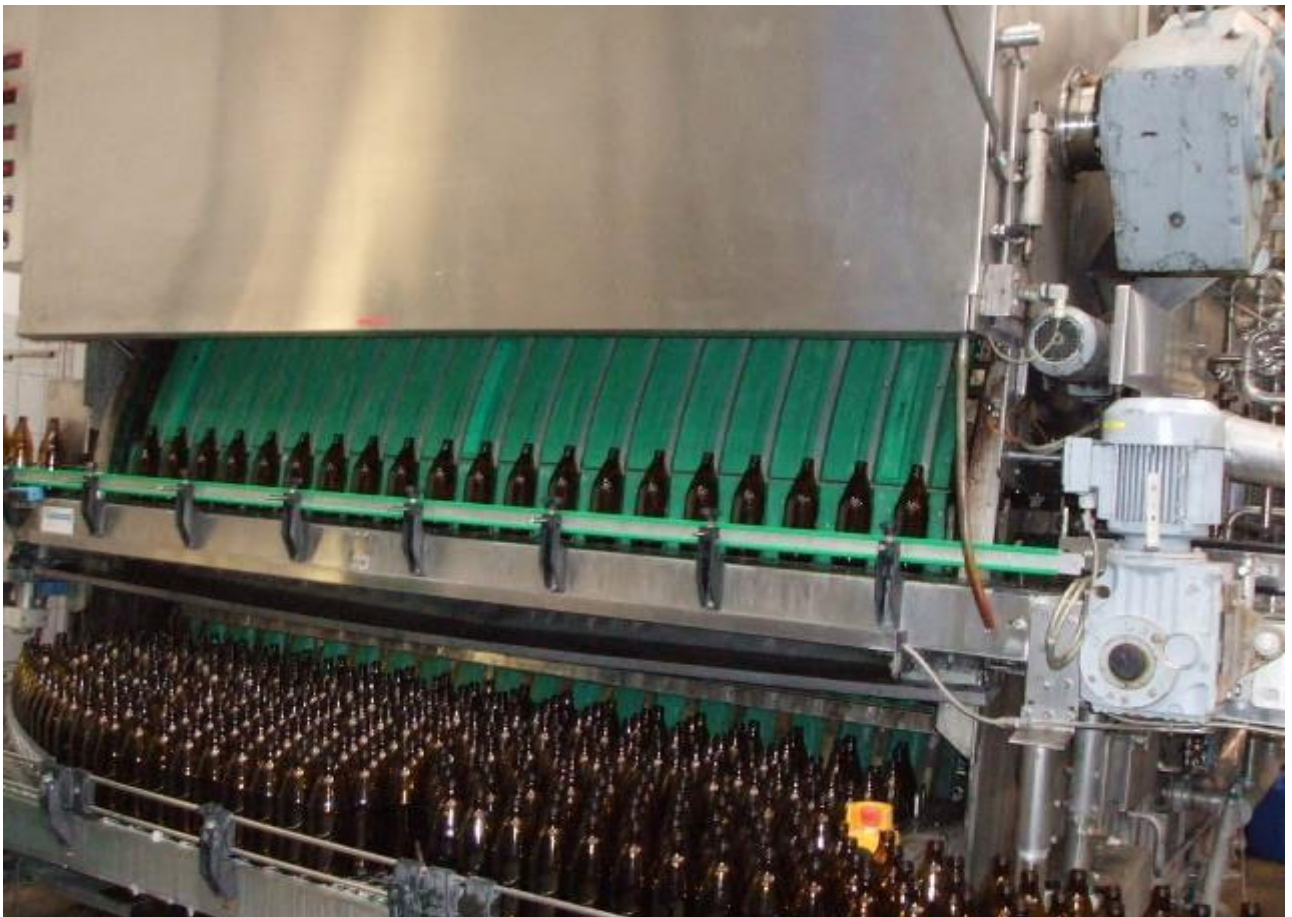
Slika 7.5. Unošenje boca u praonik
