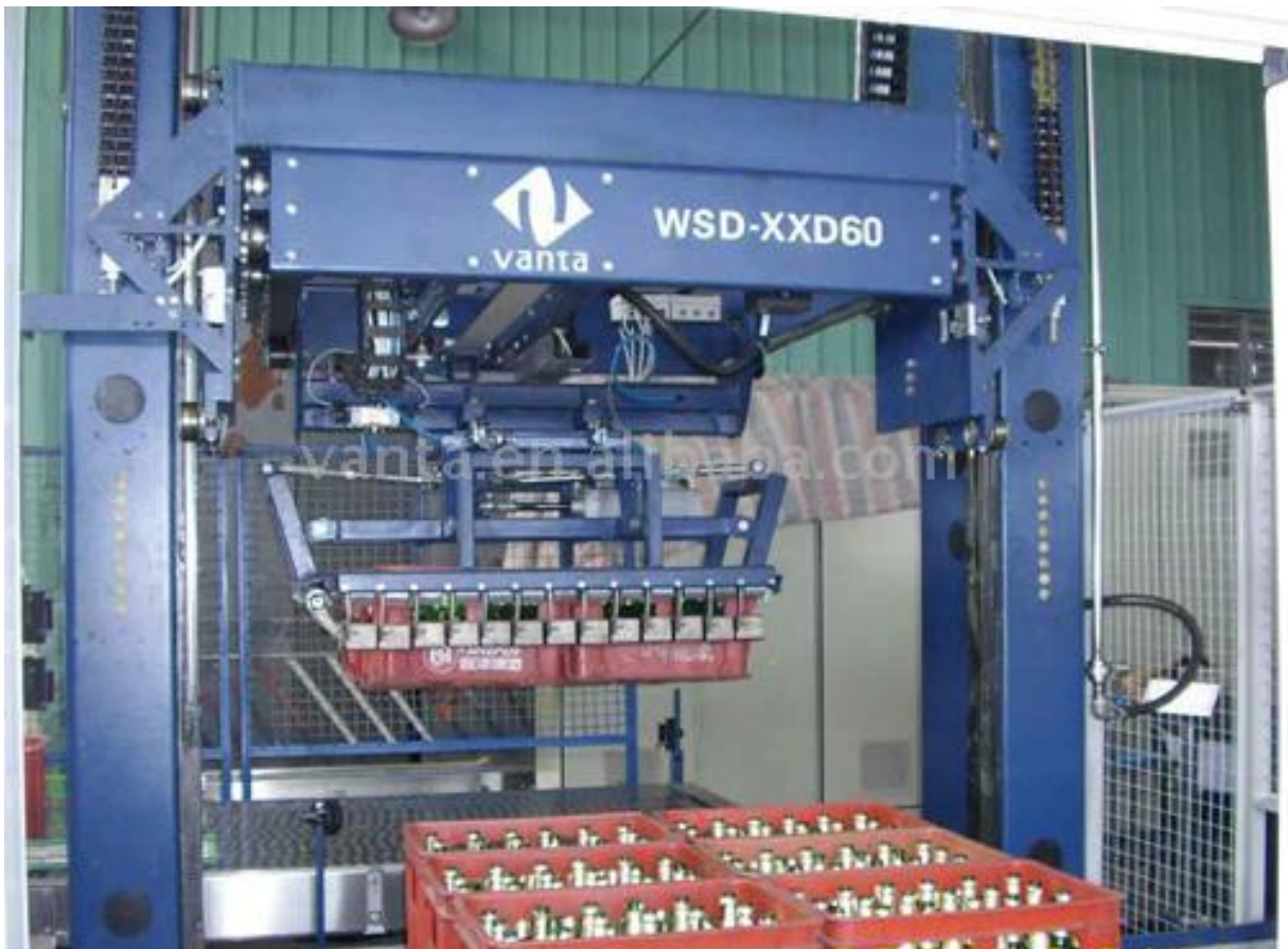
Slika 7.3. Stroj za vađenje boca iz gajbi
