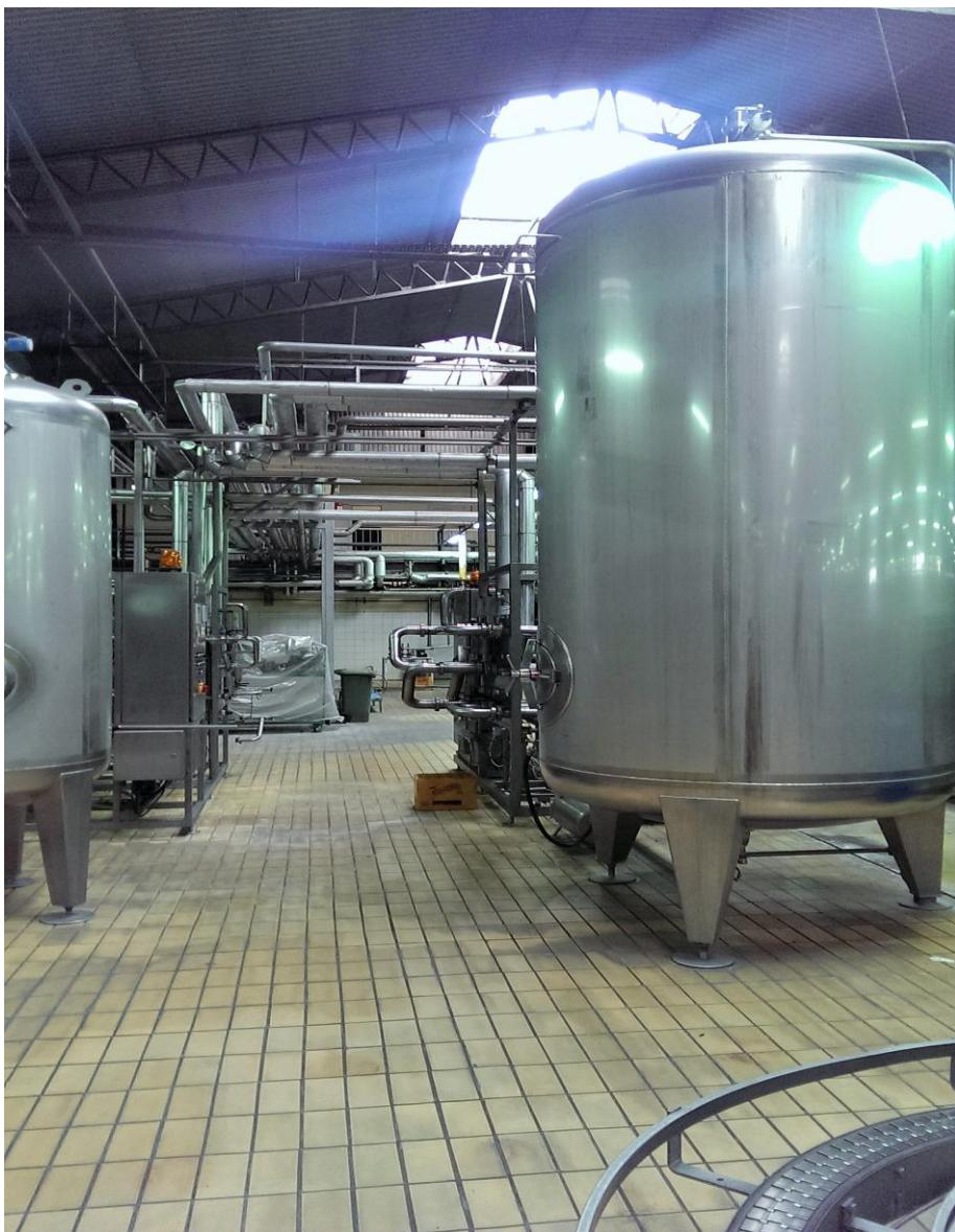
Slika 7.1. Tlačni tankovi u pogonu za pasterizaciju
