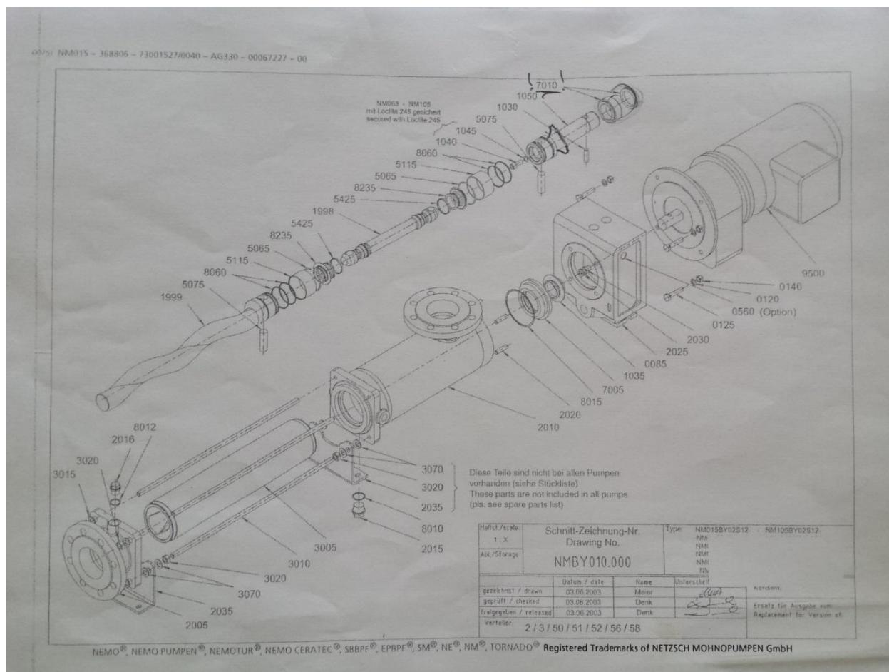
*Slika 5.3. Shema pumpe za dovod gnojevke s farme [fotografiрано 8. lipnja 2015.]*
