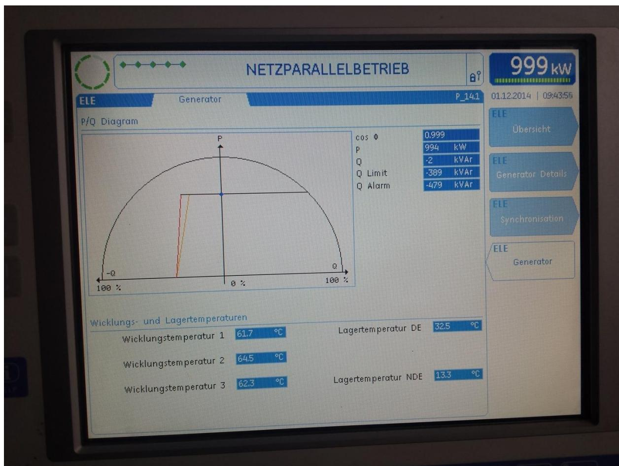
*Slika 5.17. P/Q dijagram generatora [fotografirano 1. prosinca 2014.]*
