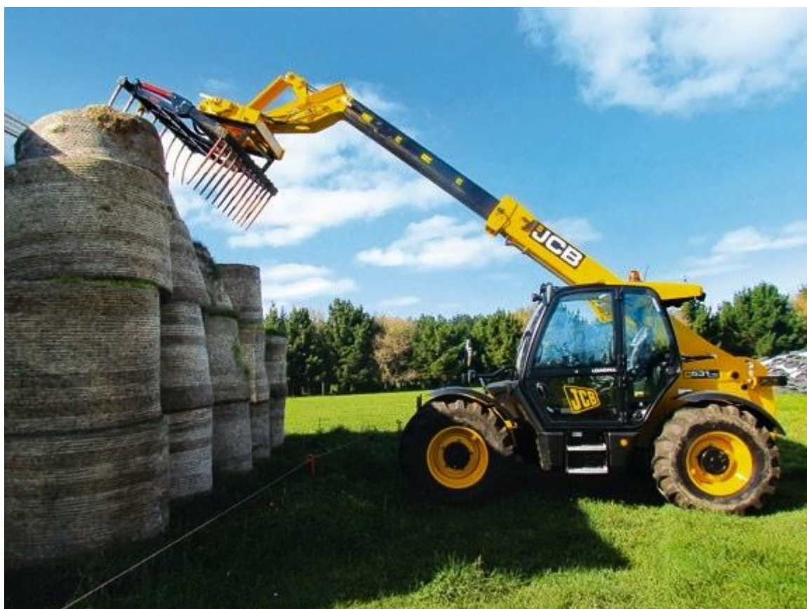
Slika 5.6. Teleskopski manipulator (slika preuzeta s interneta)
