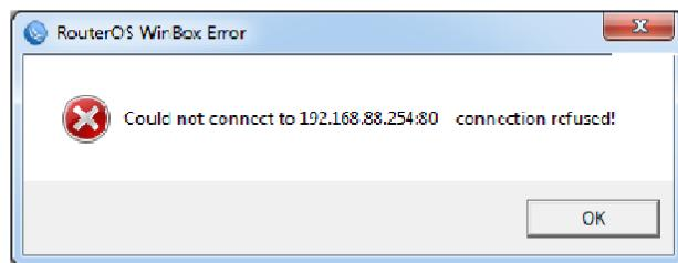
Slika 7.5. Onemogućena konekcija računala i MikroTik usmjerivača
