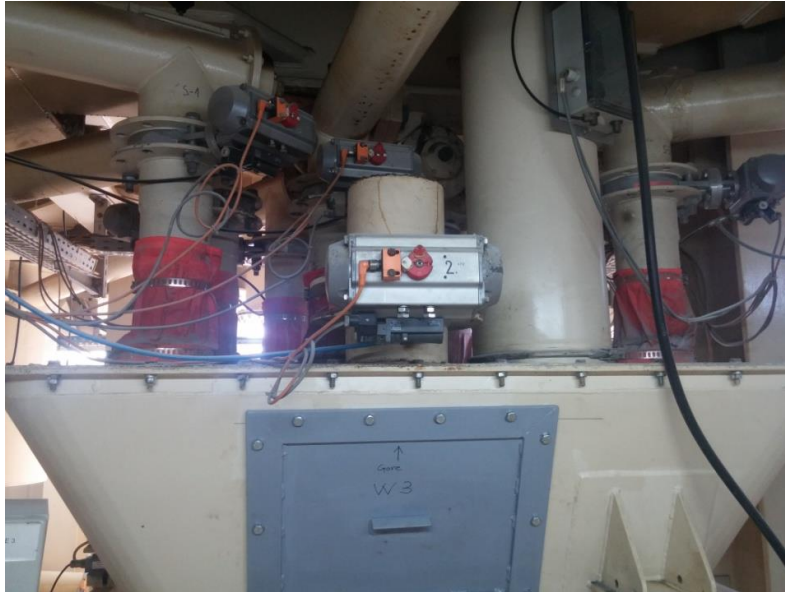
Slika 3.9. Prikaz vage 3 (manje točnosti), njenih motora i automatike
