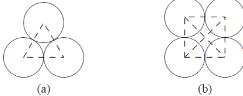
Slika 3.2. Presjek upletenog vodiča, [9].
