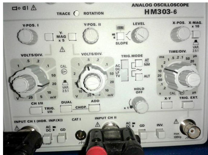
Sl. 2.5. Položaj mjernih područja na osciloskopu pri mjerenju petlje histereze
