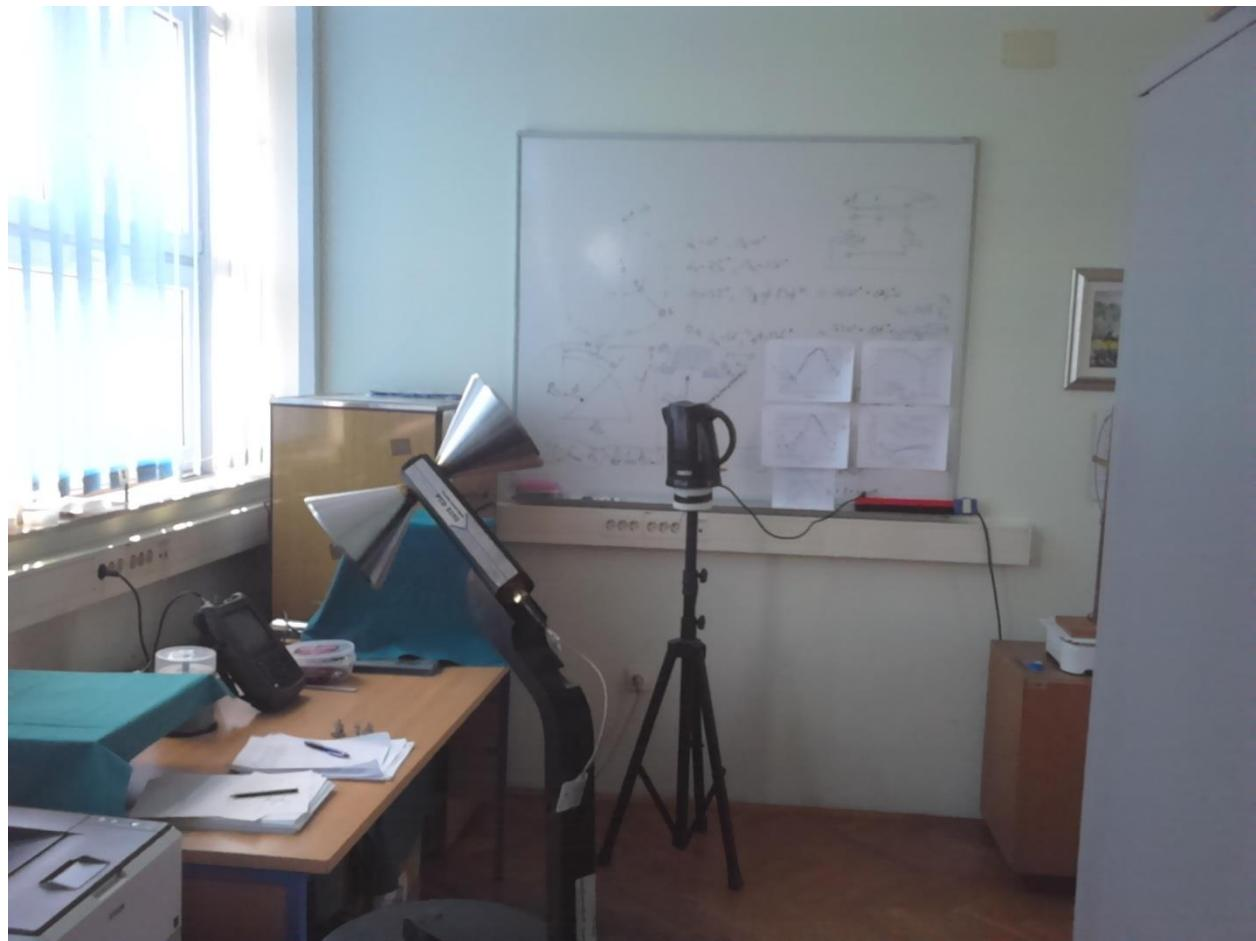
**Slika P.2.** Prikaz laboratorijskog mjerenja EMI električnog kuhalja za vodu do pola napunjene vodom na udaljenosti 3 m od antene
