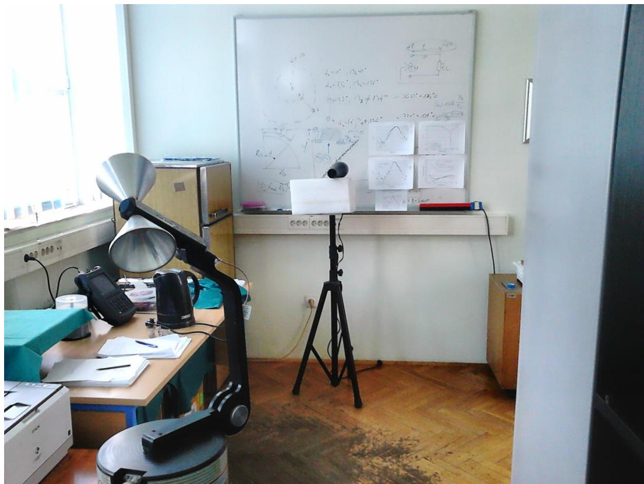
**Slika P.3.** Prikaz laboratorijskog mjerjenja EMI električnog fena za kosu u različitim modovima rada na udaljenosti 3 m od antene
