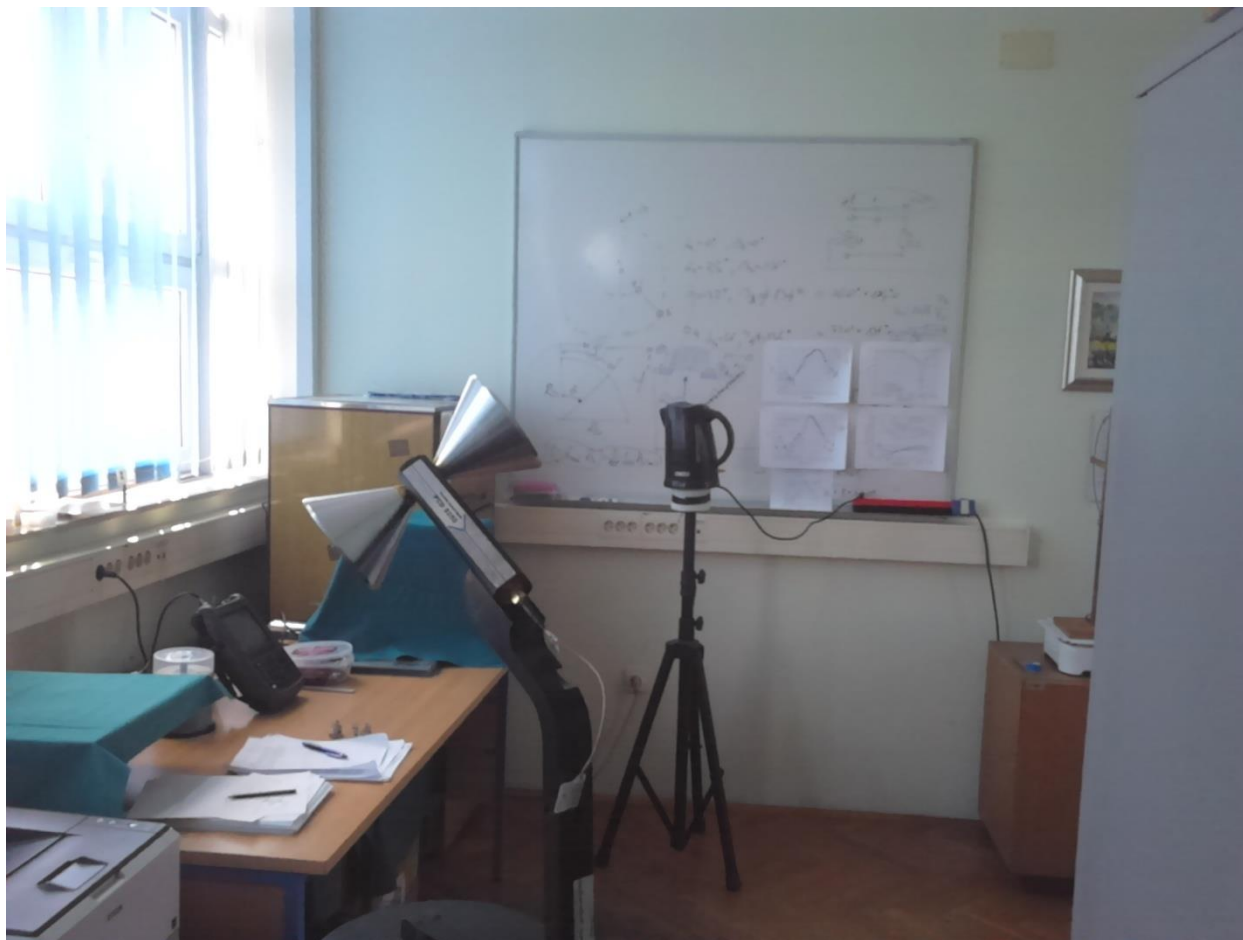
Slika P.2. Prikaz laboratorijskog mjerenja EMI električnog kuhala za vodu do pola napunjenog vodom na udaljenosti 3 m od antene
