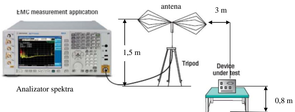
**Slika 3.2.** Shema povezivanja antene i mjernog uređaja. [1]
