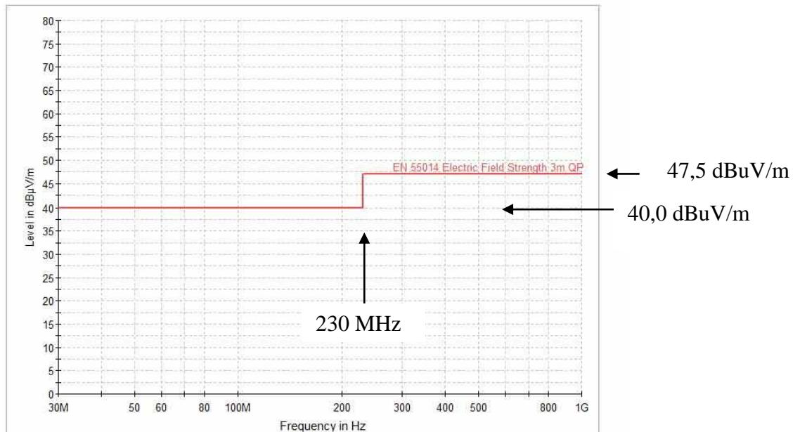
**Slika 3.1.** Prikaz granica mjernih rezultata prema EUOPSKOJ NORMI EN 55014-1:2006 [1]
