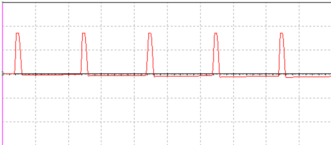
Sl. 4.11. Strujni valni oblik kolektorske struje I_C za sinusnu pobudu amplitude 10 V (pojačalo sa sinkroniziranim radom).
