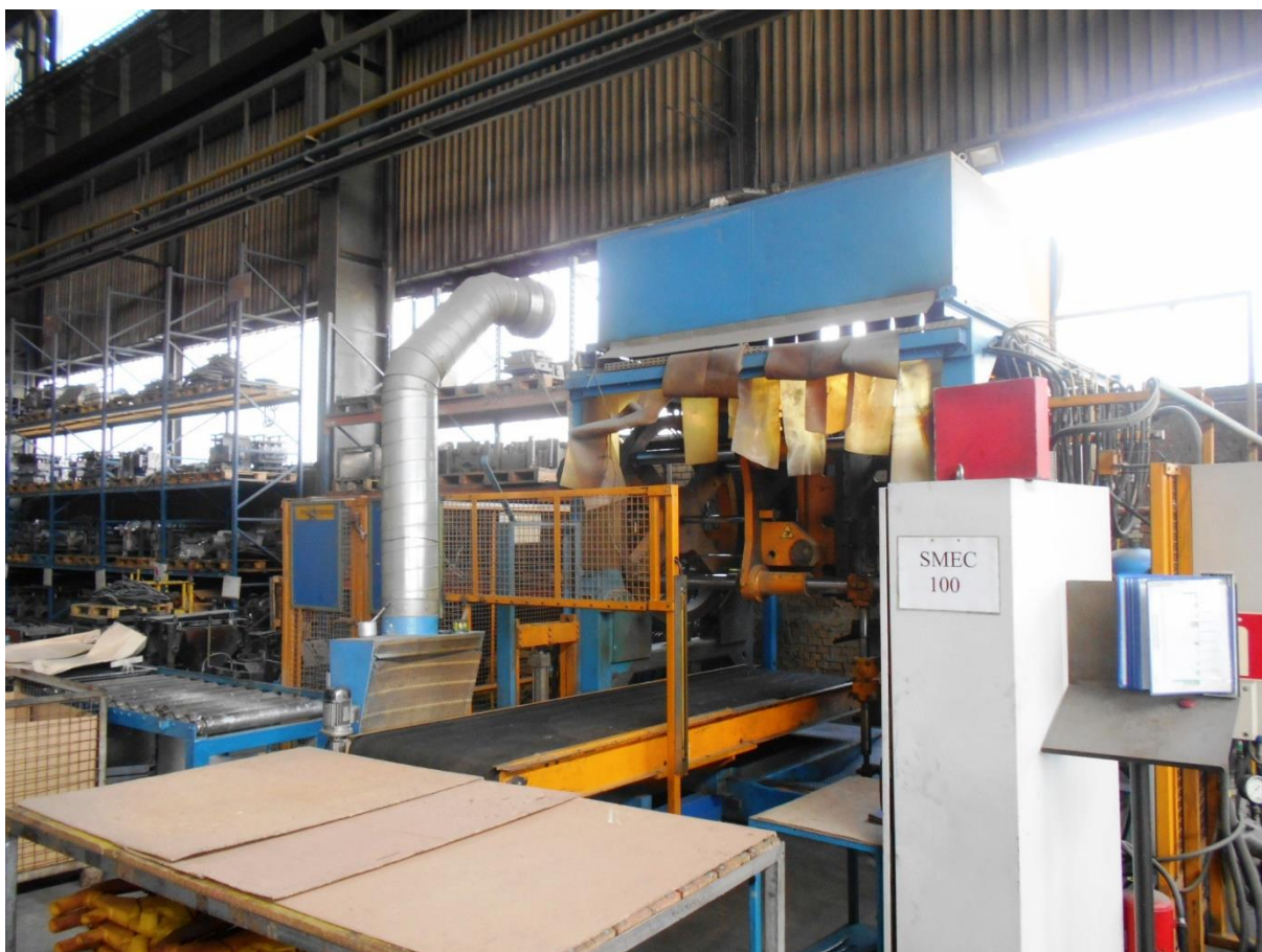
Slika 2.5. Stroj za izradu jezgri
