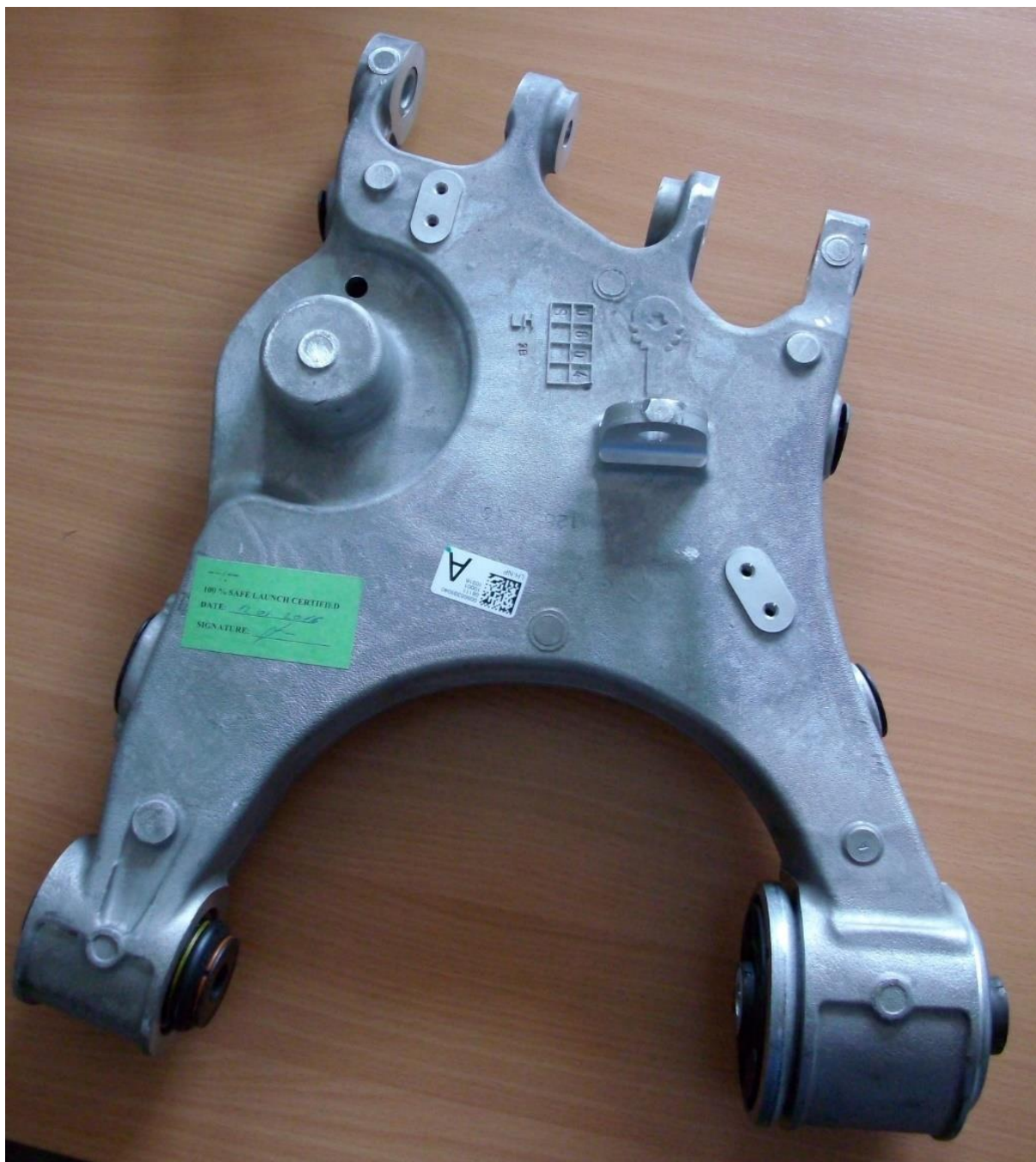
Slika 2.14. Izgled gotove kontrolne ruke spremne za prodaju
