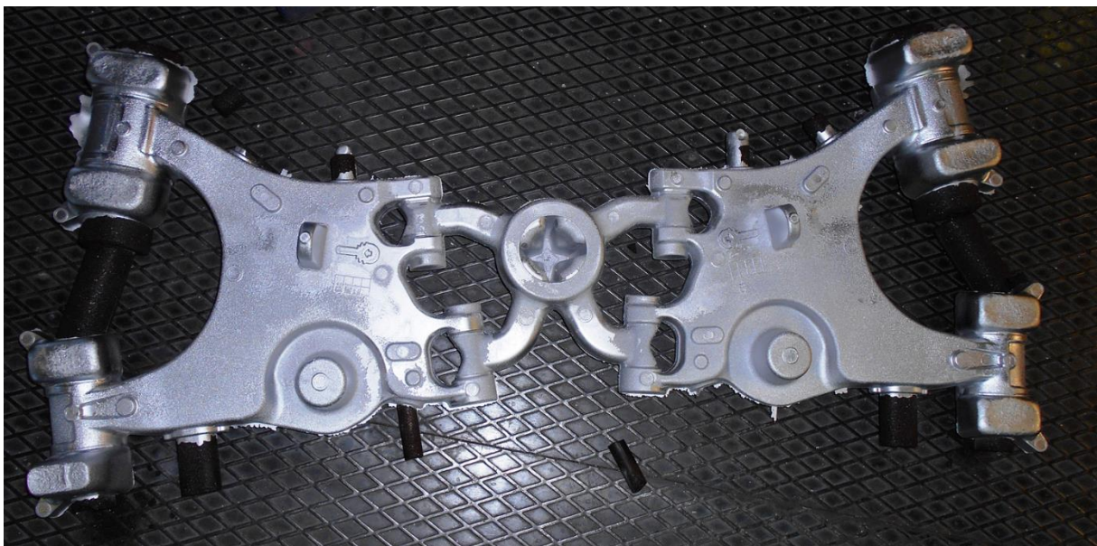
Slika 2.6. Odljevci nakon ljevanja s pješčanom jezgrom
