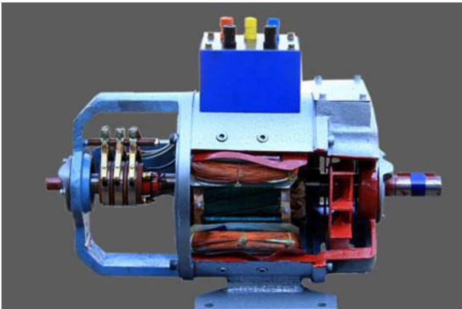
Slika 4.6. Presjek klizno kolutnog motora
