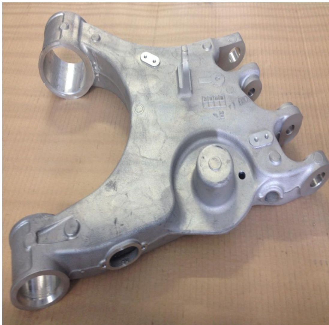
Slika 2.13. Izgled obradka nakon strojne obrade
