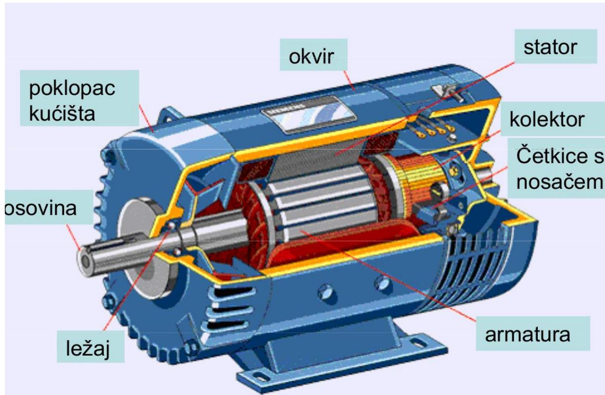
**Slika 4.1.** Poprečni presjek klasičnog istosmjernog stroja
