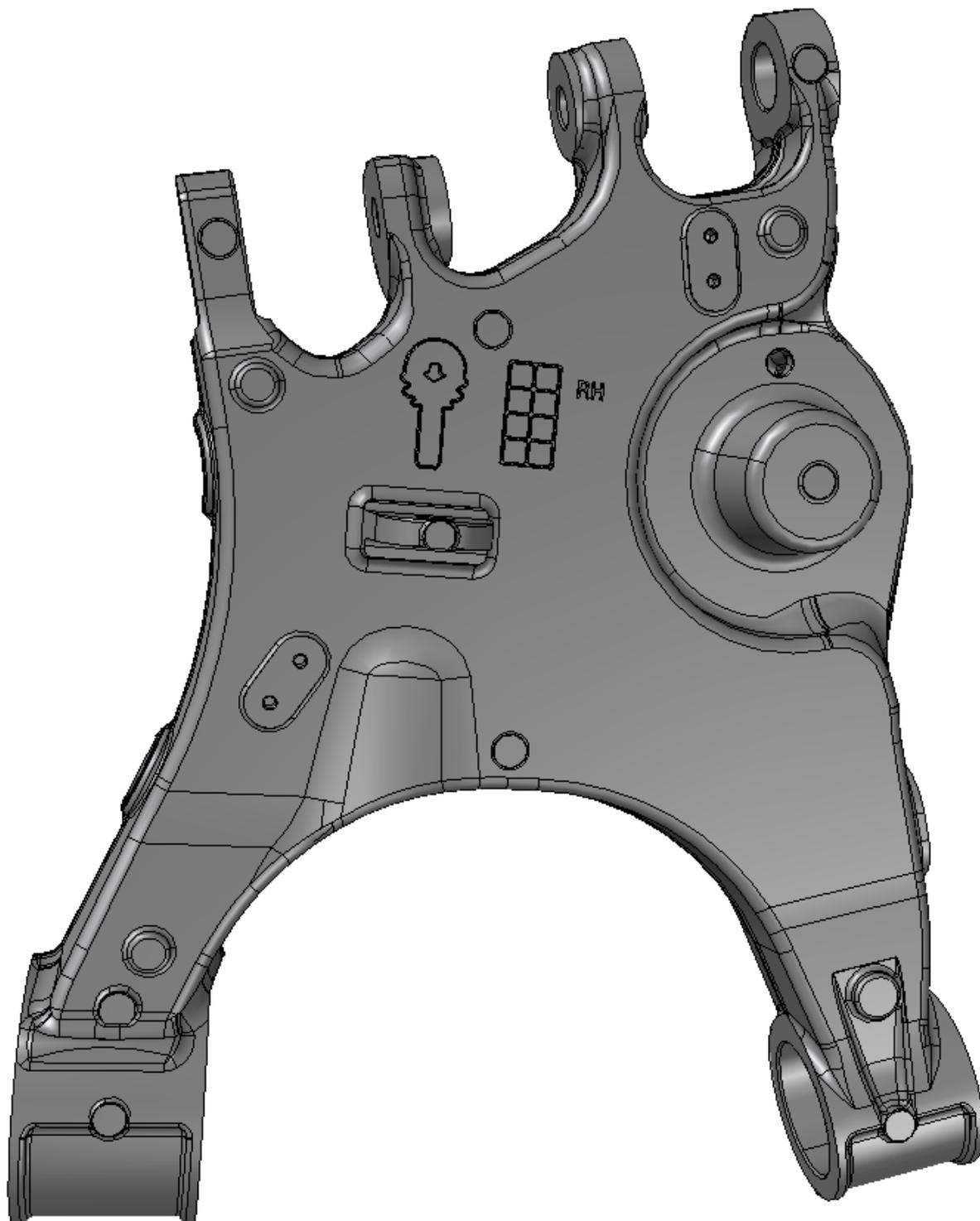
**Slika 2.12.** Simulacija izgleda odljevka nakon strojne obrade
