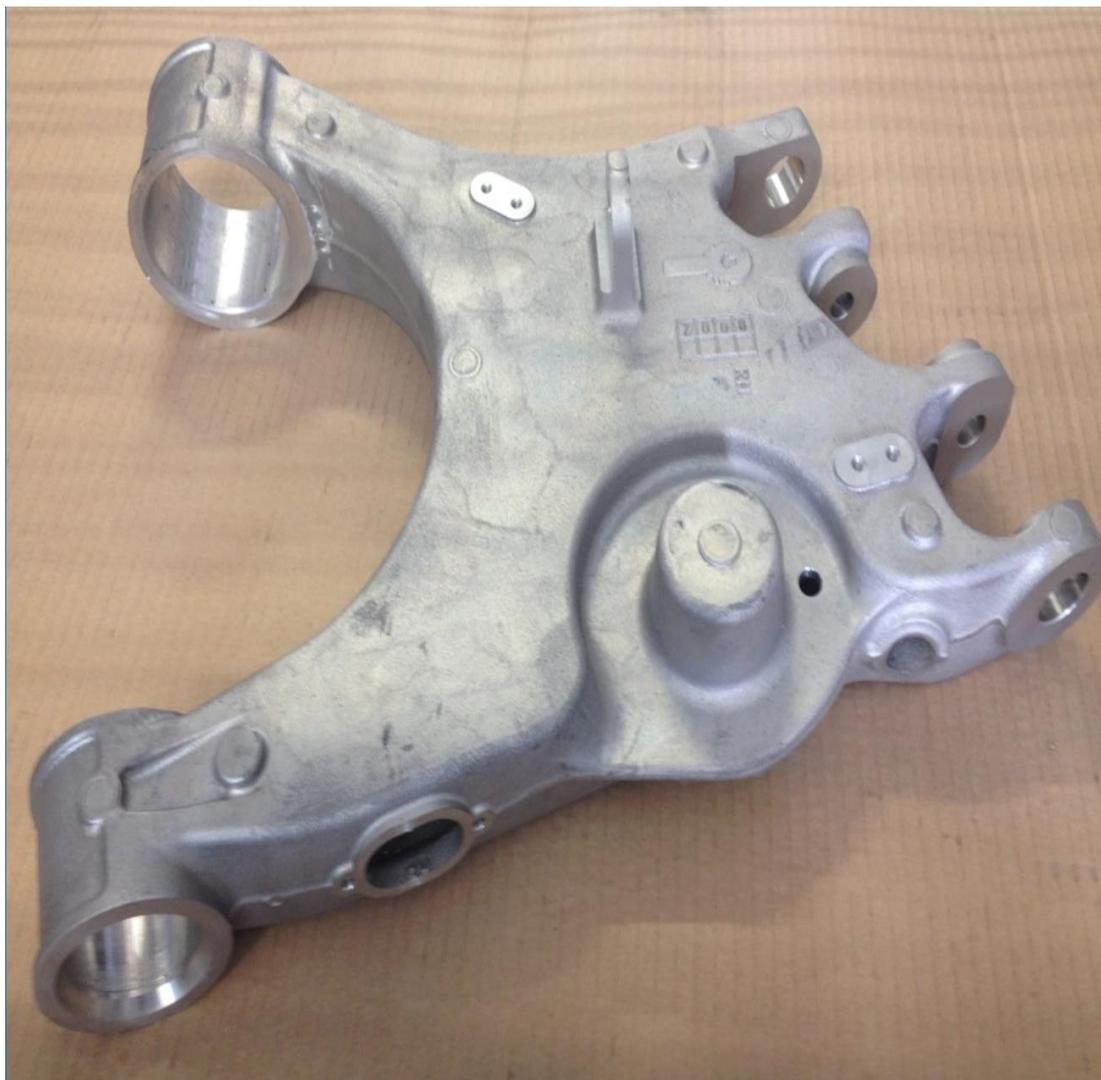
**Slika 2.13.** Izgled obradka nakon strojne obrade
