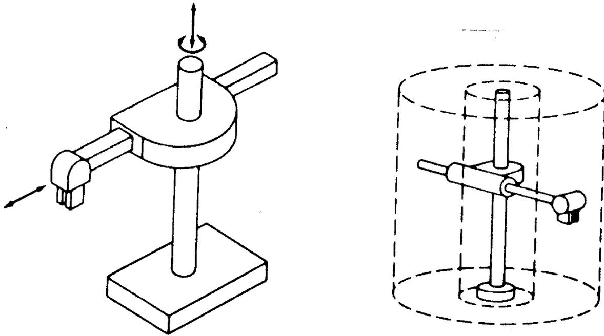
**Slika 3.4.** Cilindrična konfiguracija industrijskog robota.
