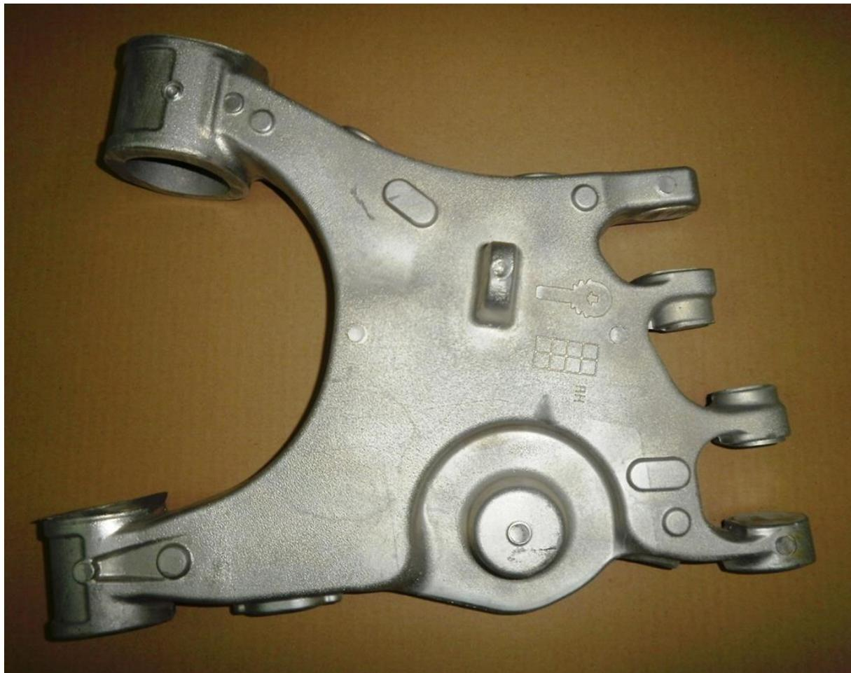
**Slika 2.7.** Izgled aluminijskog komada nakon uklanjanja pijeska
