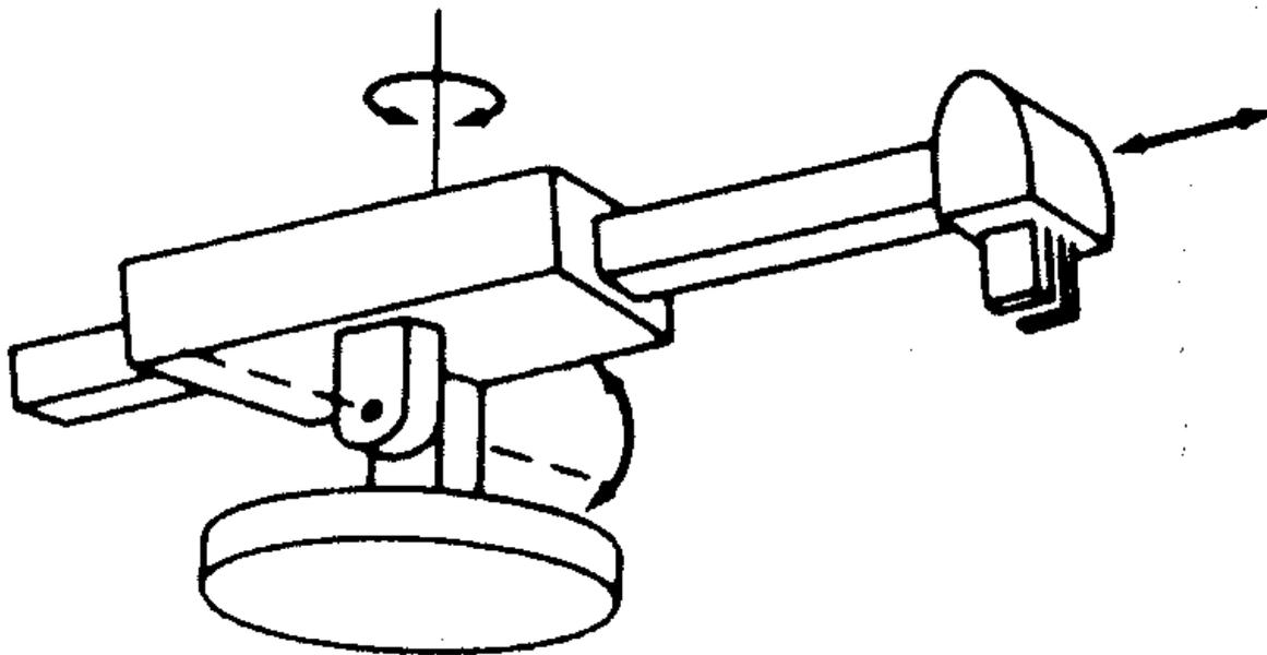
**Slika 3.3.** Polarna konfiguracija industrijskog robota
