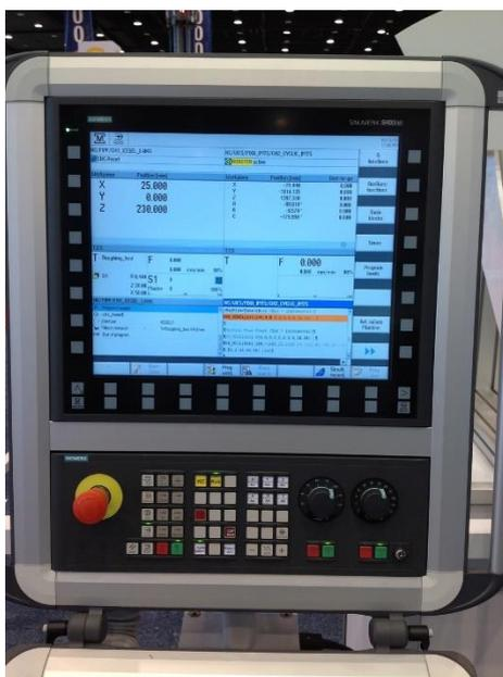
**Slika 3.13.** Sinumerik 840D sl računalo**4. ELEKTROMOTORNI POGON BA W06-22**
