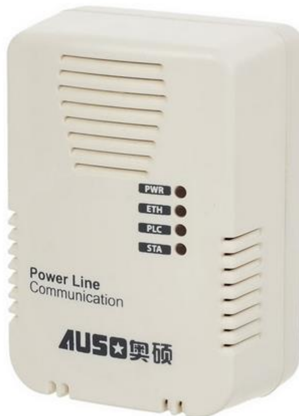
Slika 1. Korišteni AUSO PLC uređaj
