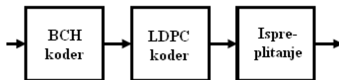
Sl. 2.1. Shema DVB-T2 zaštite od pogrešaka
