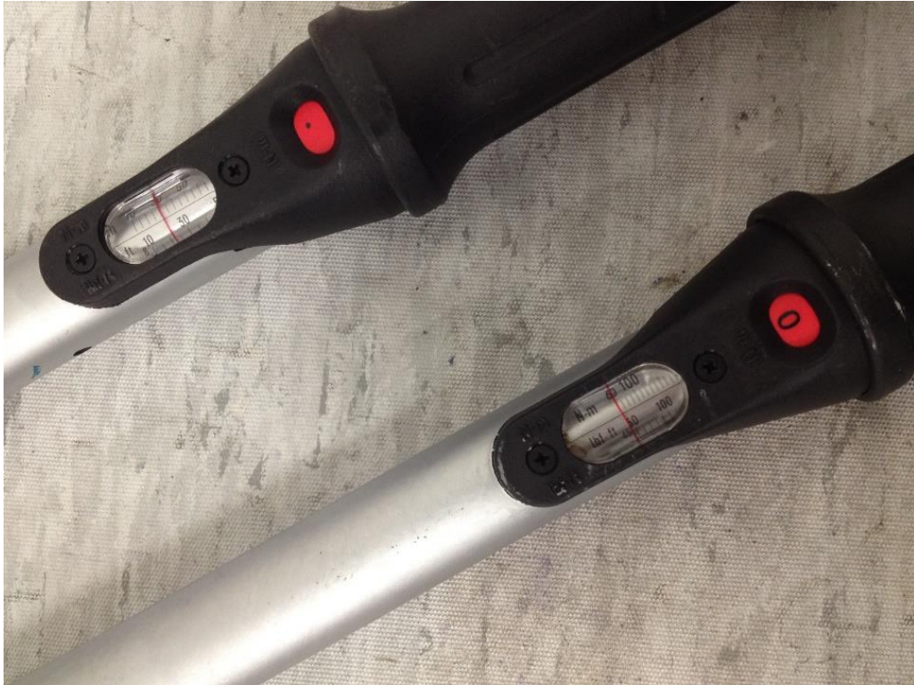
Sl. 3.3. Podešavanje moment ključeva, analogna skala
