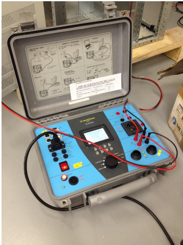
Sl. 3.4. i 3.5. „CE MultiTester MI2094“ proizvođača METREL
