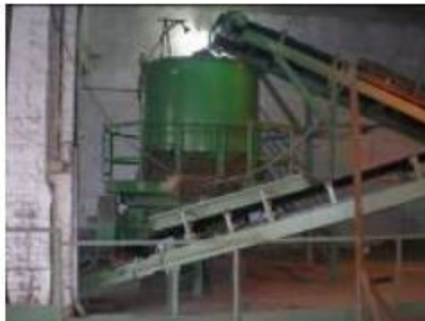
Slika 4.2. Mlin za glinu [7, str. 10]
