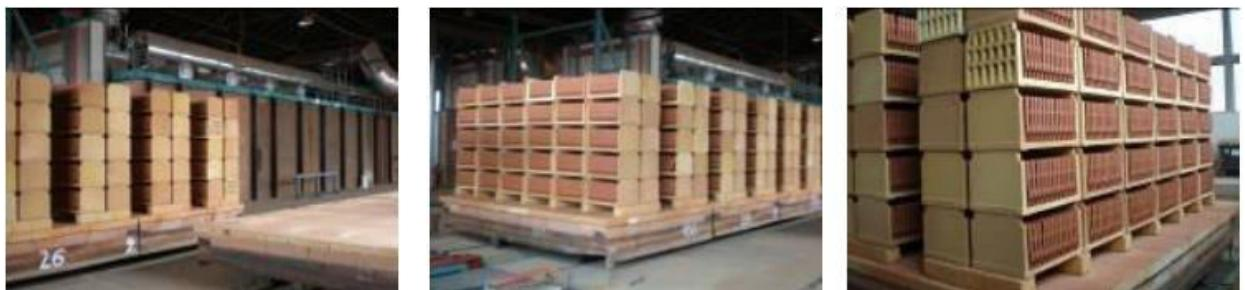
**Slika 4.7.** Izvoz crijeva iz peći [7, str. 21]
