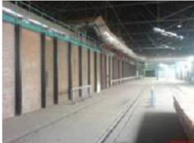
Slika 4.5. Tunelska peć [7, str. 15]
