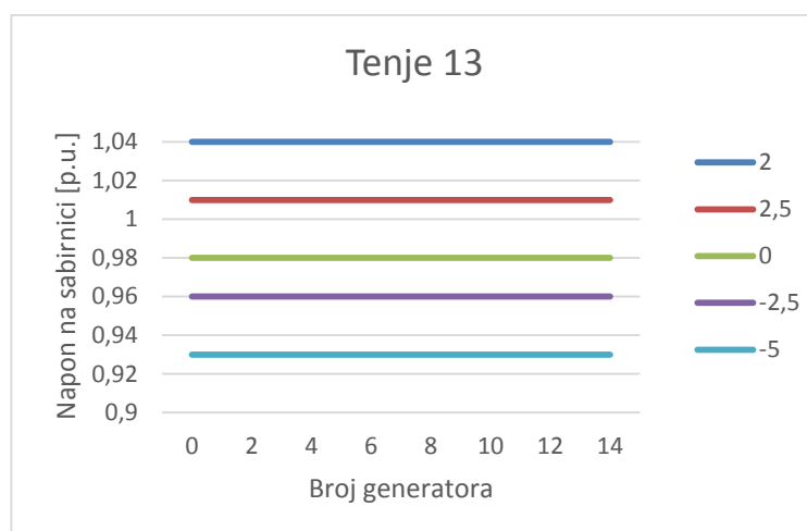
Slika 3.3. Utjecaj broja generatora na napon u niskonaponskom izvodu Tenja 13
