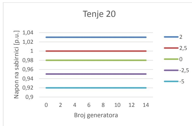
Slika 3.4. Utjecaj broja generatora na napon u niskonaponskom izvodu Tenje 20
