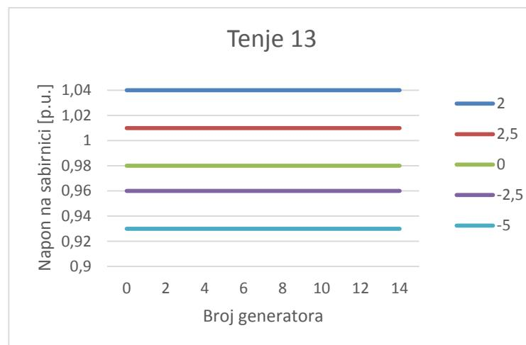
Slika 3.3. Utjecaj broja generatora na napon u niskonaponskom izvodu Tenje 13
