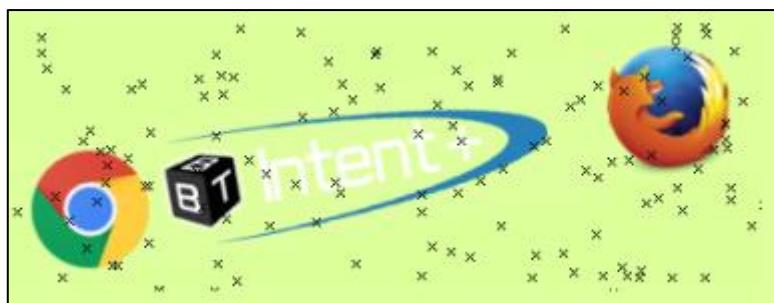
**Slika 4.5.** Primjer slike gdje je referentna slika zarotirana za  $-10^\circ$ , smanjena za 10%, 5% površine prekriveno česticama i translatirana za 10 elemenata slike u lijevo i 10 elemenata slike prema dolje.
