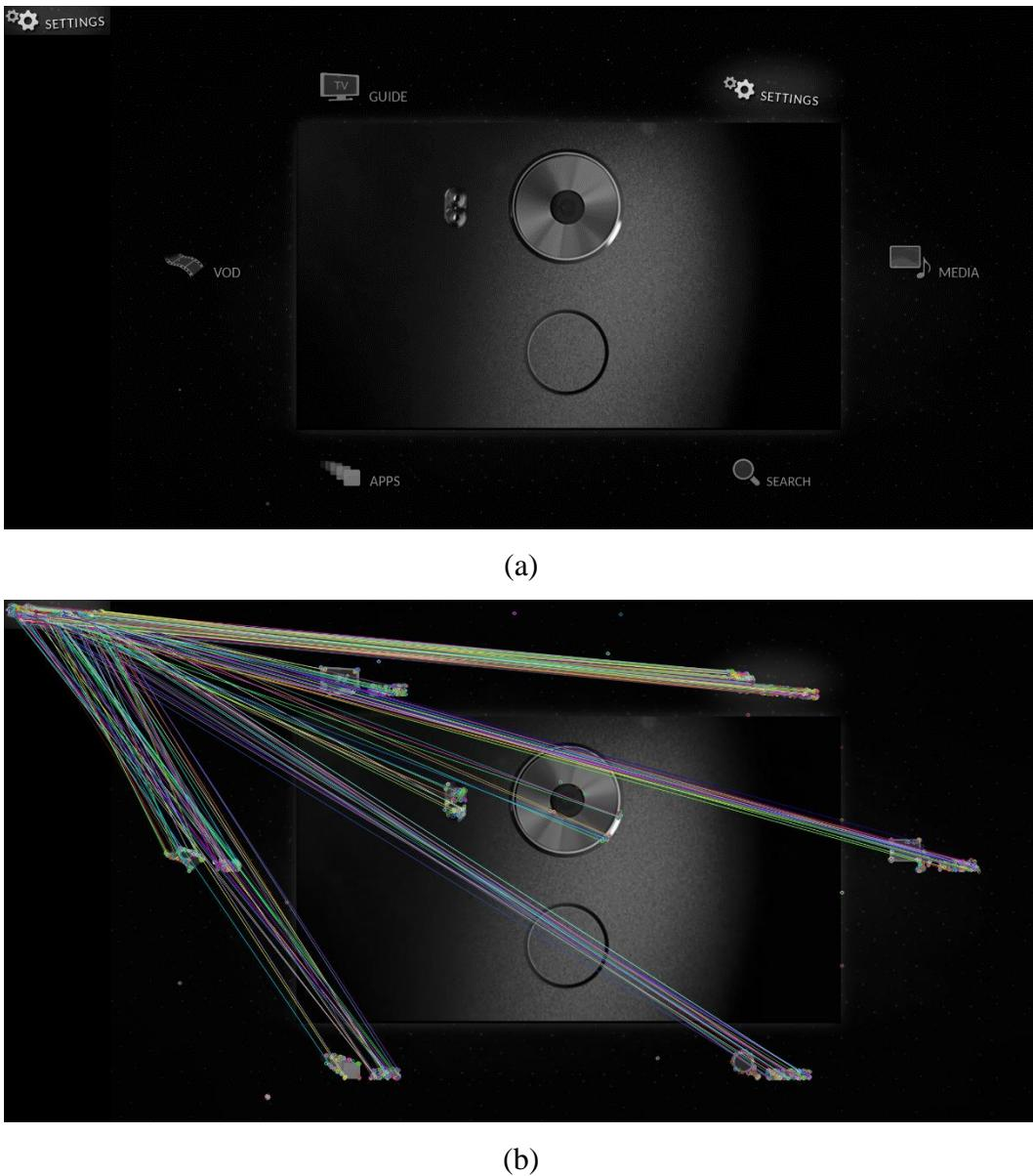
**Slika 3.3.** Primjer pogrešne detekcije ključnih točaka, referentna (gornji lijevi ugao na slikama) i testna slika (a) prije detekcije (b) nakon detekcije.
