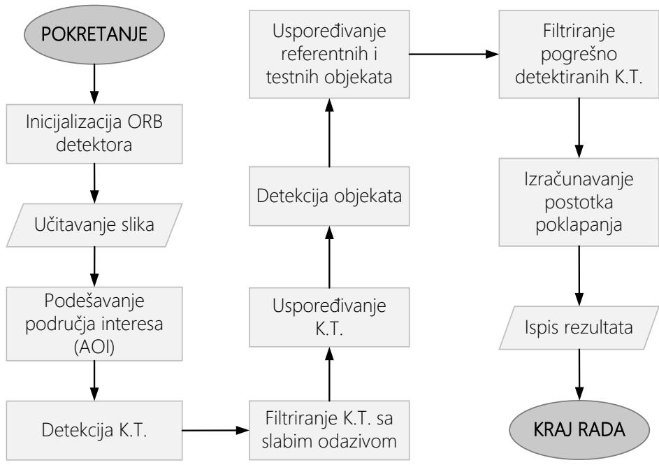
**Slika 3.1.** Dijagram toka algoritma za usporedbu dinamičnih slika.
