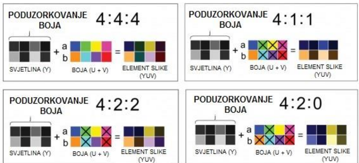
Sl. 2.2. Princip funkcioniranja glavnih tipova poduzorkovanja krominantnih komponenti [4].
