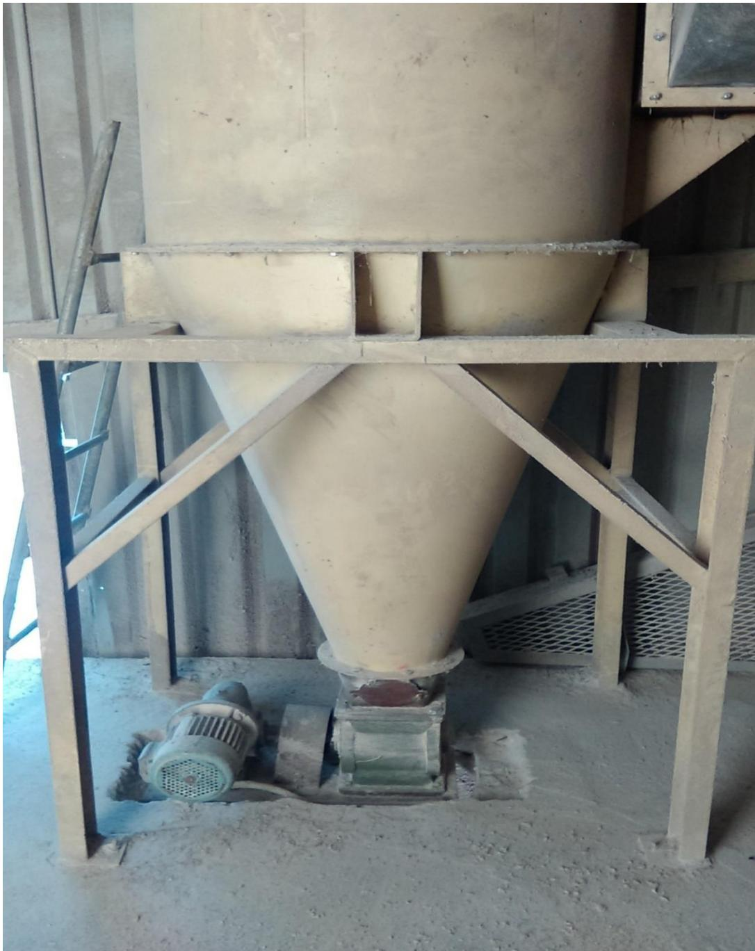
**Slika 2.10.** Ventilator (unutar skladišnog prostora) za odvajanje prašine od zrna žitarice
