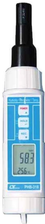
**Slika 5.6.** Termohigrobarometar „LUTRON“
