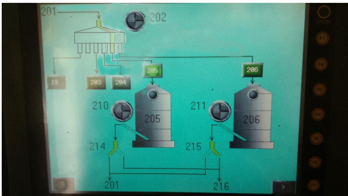
**Slika 2.19.** Prikaz motora broj 202 za punjenje čelija na zaslonu operatorskog panela Siemens
