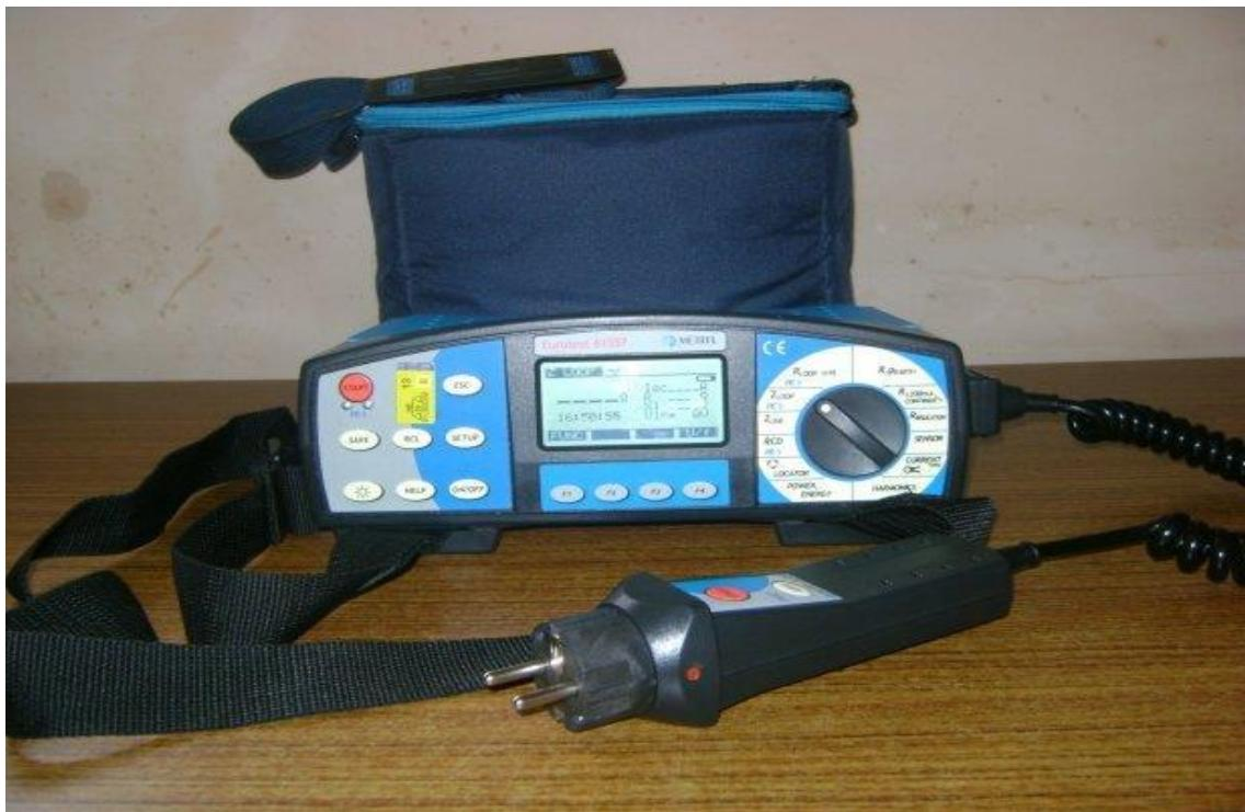
**Slika 5.4.** Mjerni instrument za mjerjenje električnih veličina „METREL“
