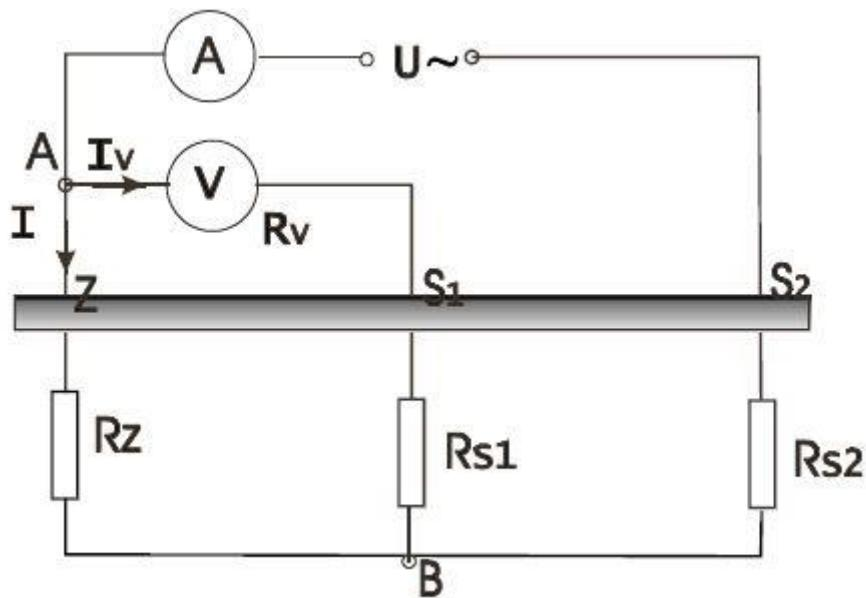
**Slika 5.3.** Nadomjesna shema mjerjenja otpora uzemljenja
