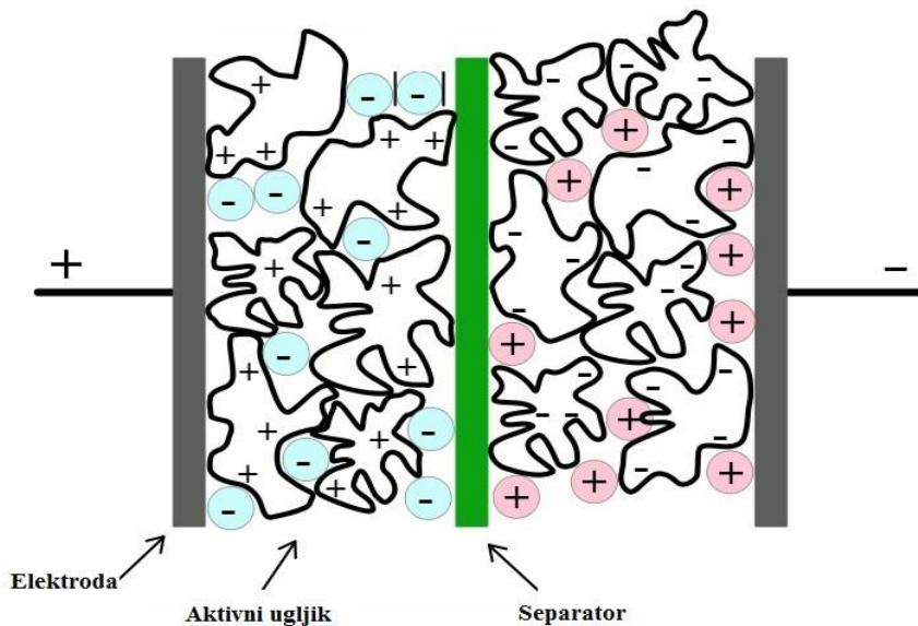
Sl. 2.9. Struktura ultrakondenzatora [17]
