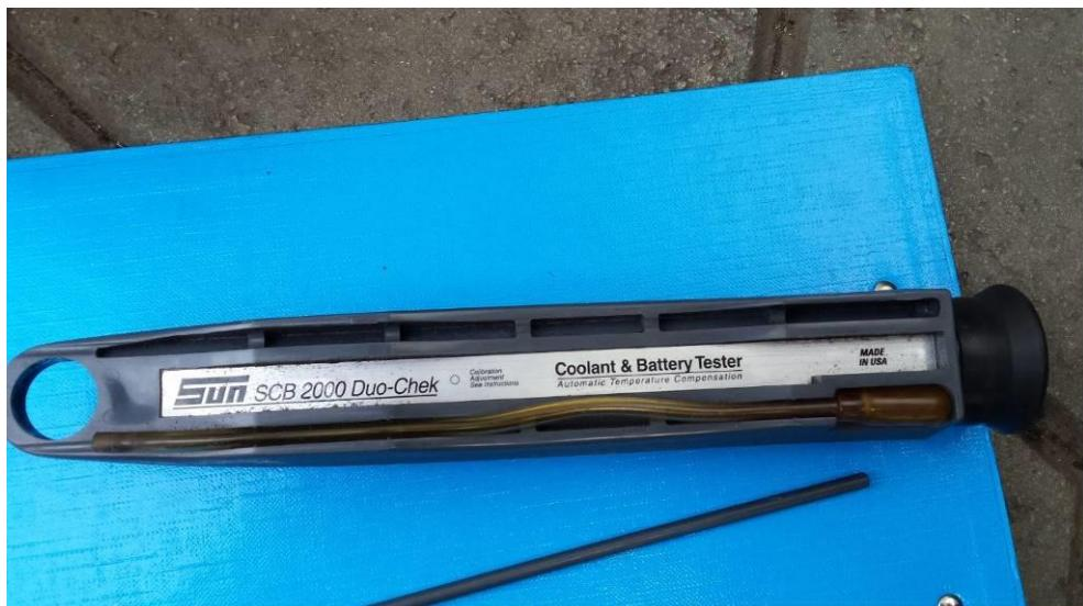
**Slika 3.4. Optički uređaj za ispitivanje gustoće elektrolita**
