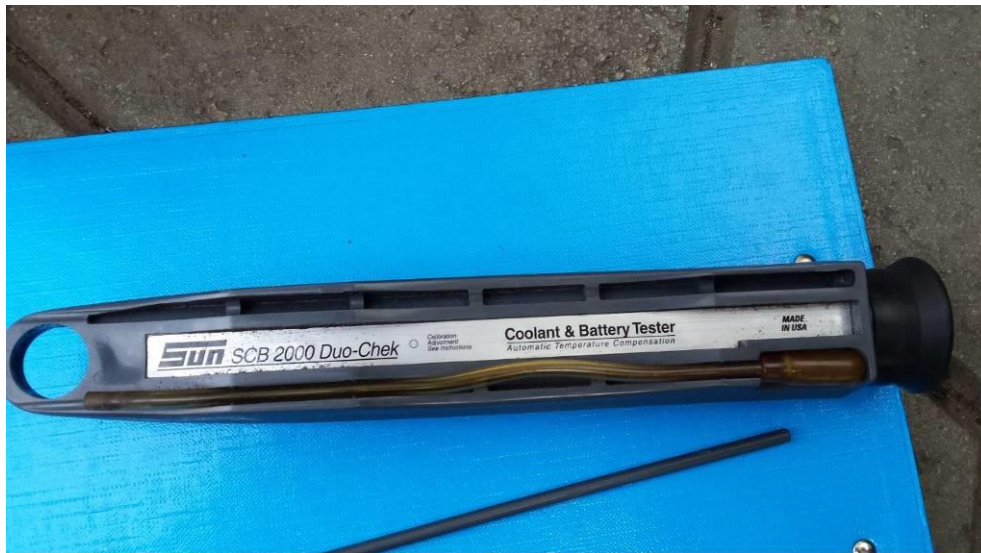
Slika 3.4. Optički uređaj za ispitivanje gustoće elektrolita
