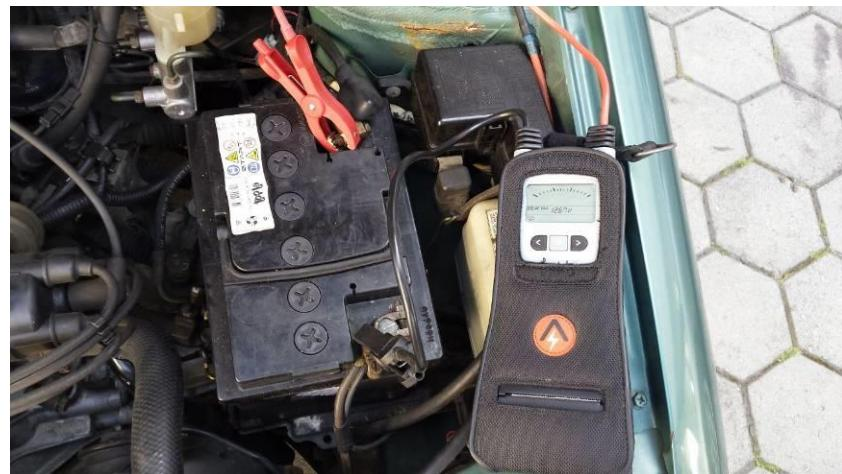
**Slika 3.9. Prikaza spajanja uređaja na akumulatorsku bateriju**
