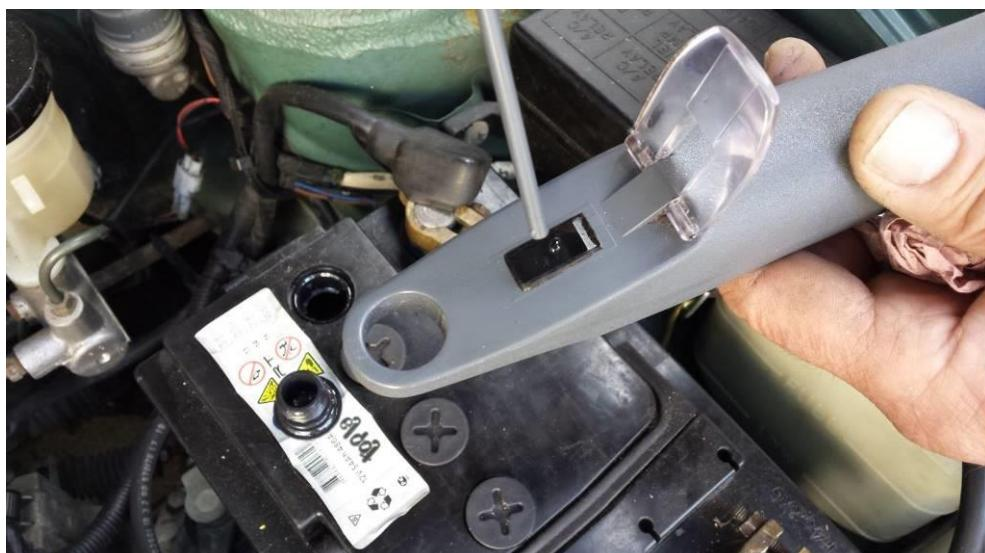
**Slika 3.6. Nanošenje tekućine na podlogu za ispitivanje**
