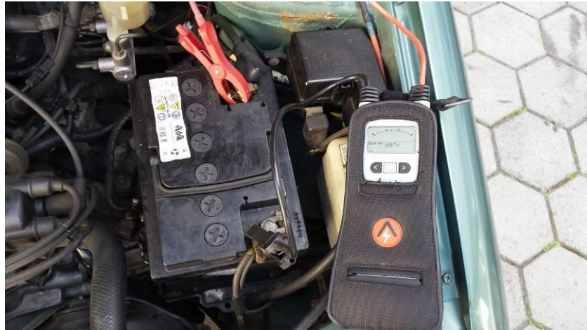
Slika 3.9. Prikaza spajanja uređaja na akumulatorsku bateriju
