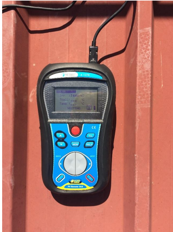
Slika 4.8. Mjerni instrument Metrel A1378 prilikom obavljanja mjerenja.
