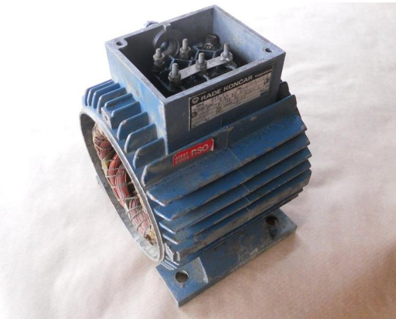
*Slika 4.1. Stator i priključna kutija trofaznog asinkronog kavezognog elektromotora*
