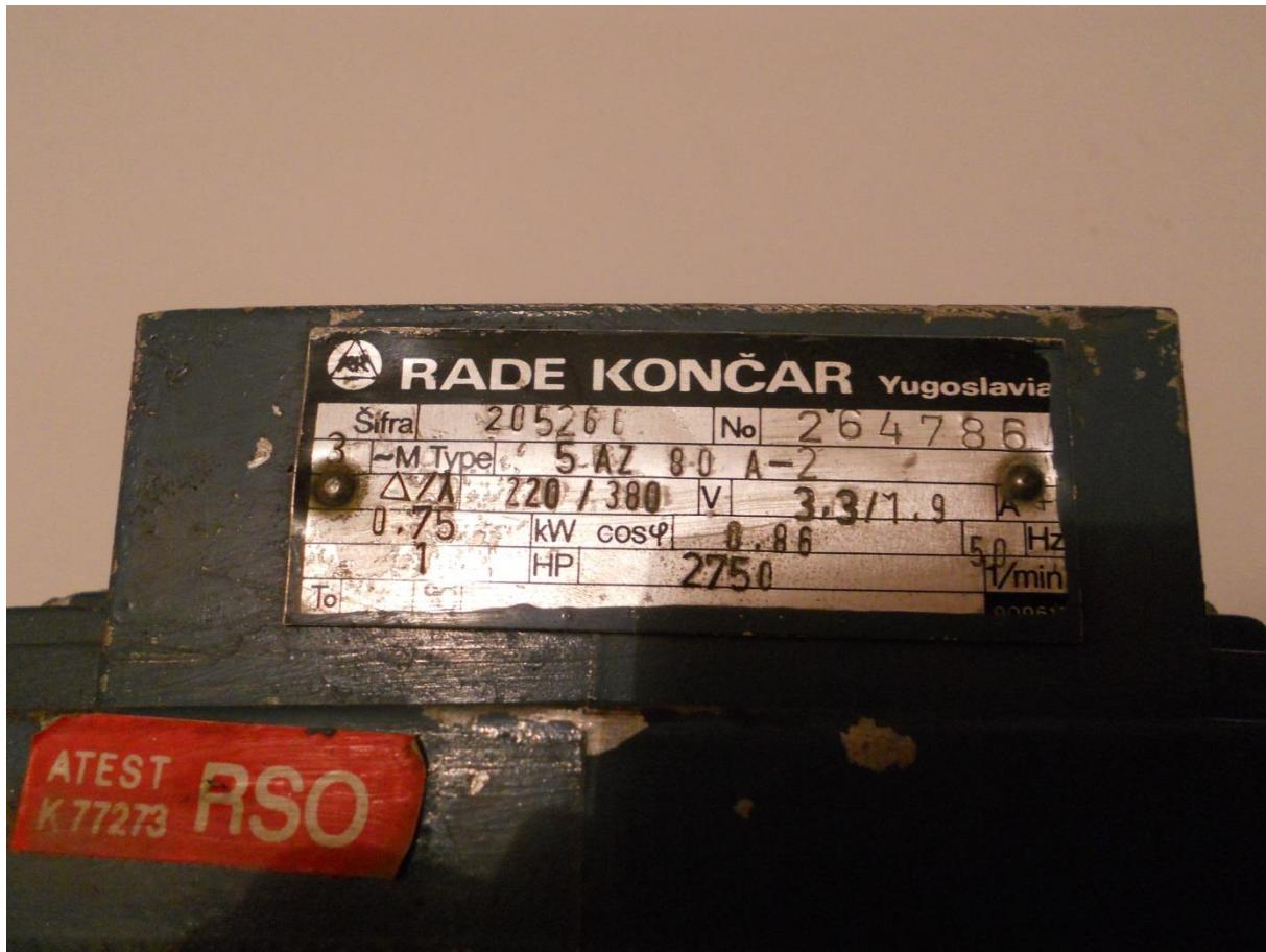
*Slika 4.3. Natpisna pločica trofaznog asinkronog kavezognog elektromotora*
